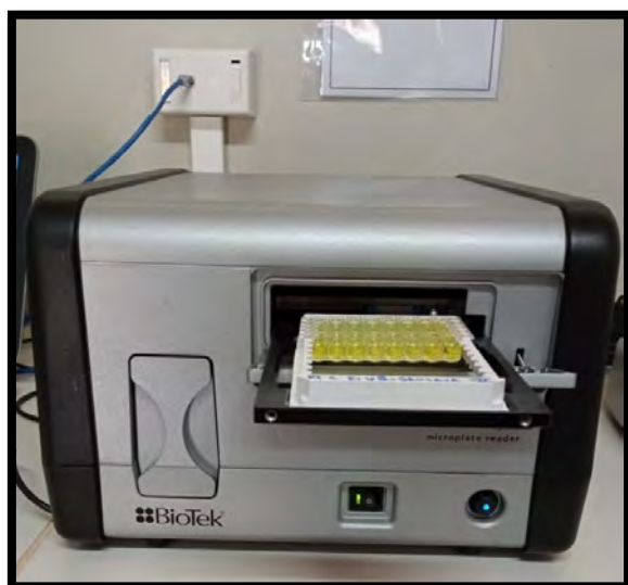
Figura 36. Lectura de las densidades ópticas a 450 nm de longitud de onda en el lector de microplacas ELISA.
