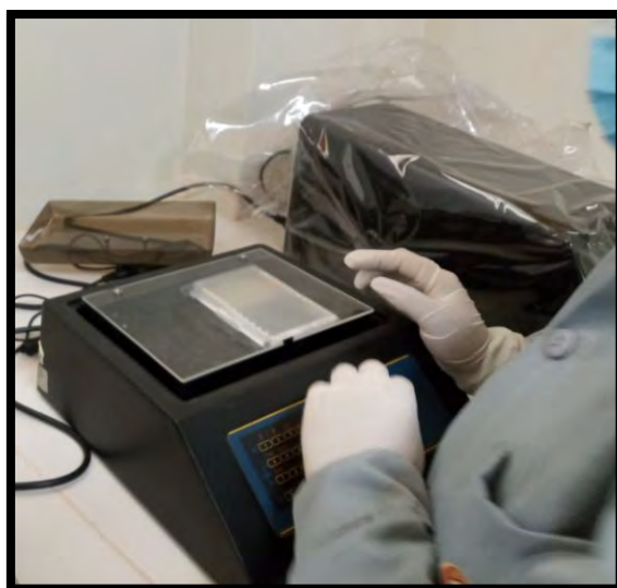
Figura 29. Sellado de la placa e incubación la placa durante 60 minutos a 22 °C.
