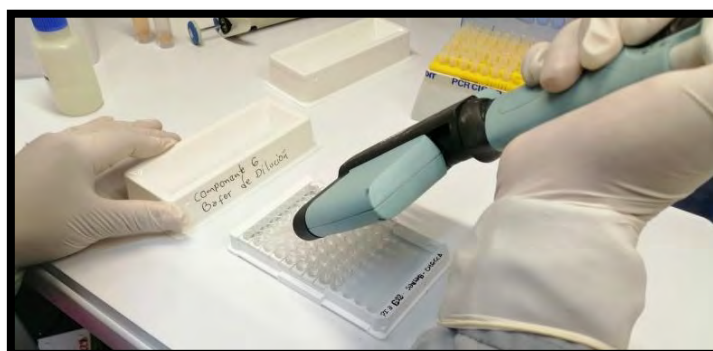
Figura 27. Adición de 50 \mu L del tampón de dilución n° 6 a todos los pocillos.
