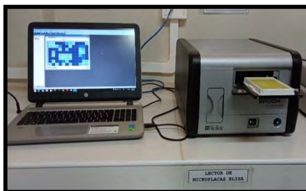
Figura 26. Lectura de la placa con el lector de densidad óptica a 450 nm de longitud de onda.
