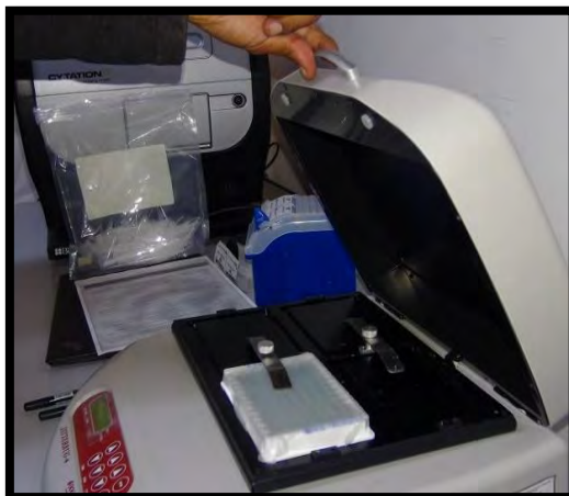
Figura 23. Segundo lavado de la microplaca con 300 \mu L de solución de lavado por 5 veces.
