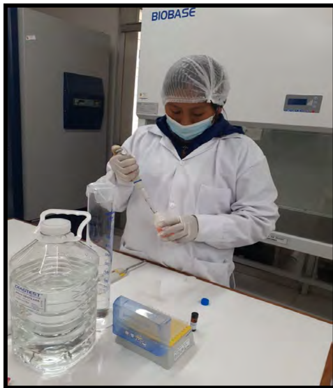
Figura 12. Preparación de solución de lavado y conjugado.
