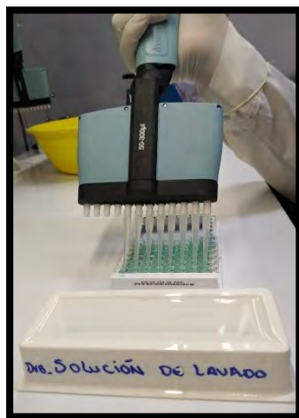
Figura 20. Primer lavado de los pocillos de la placa con 300 \mu L de solución de lavado por 5 veces.
