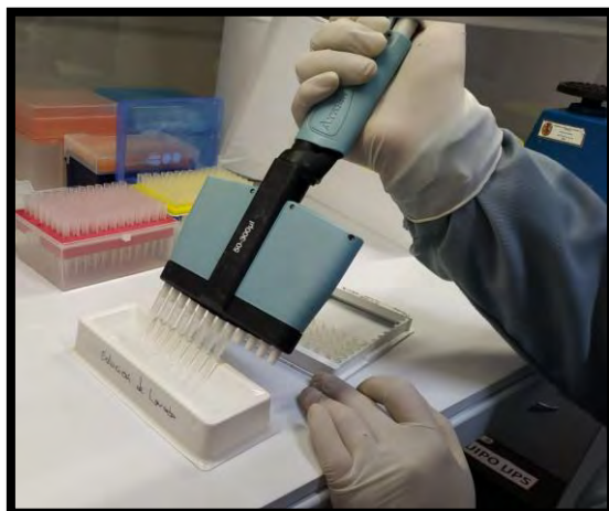
Figura 33. Segundo lavado de los pocillos de la placa con 300 \mu L por 6 veces.
