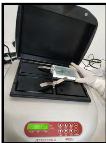
Figura 19. Incubación de las muestras cubiertas con cinta Parafilm a 26°C por 1 hora.
