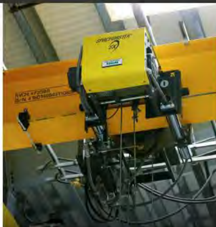
Equipo clasificado para ubicaciones peligrosas de Clase I, División 2 en una central eléctrica municipal.
