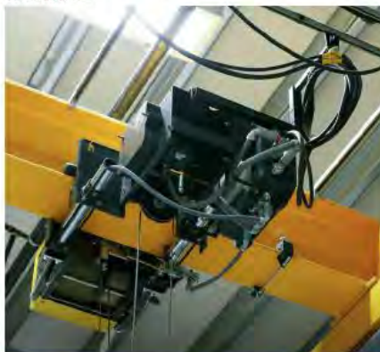
Equipo clasificado para ubicaciones peligrosas de Clase I, División 2 en una central eléctrica municipal.
