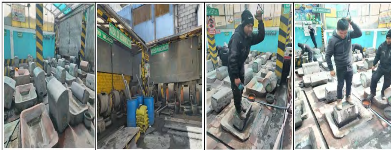
Figura 6. Procesamiento del oro mediante molienda del mineral en quimbaletes.
