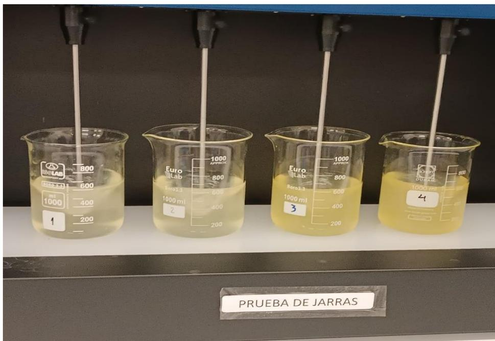
Finalizando el tiempo de pruebas, se filtraron las soluciones y posteriormente fueron remitidas al laboratorio HidroLab S.A.C. para su respectivo análisis de concentración de arsénico III. (ver figura 19)
