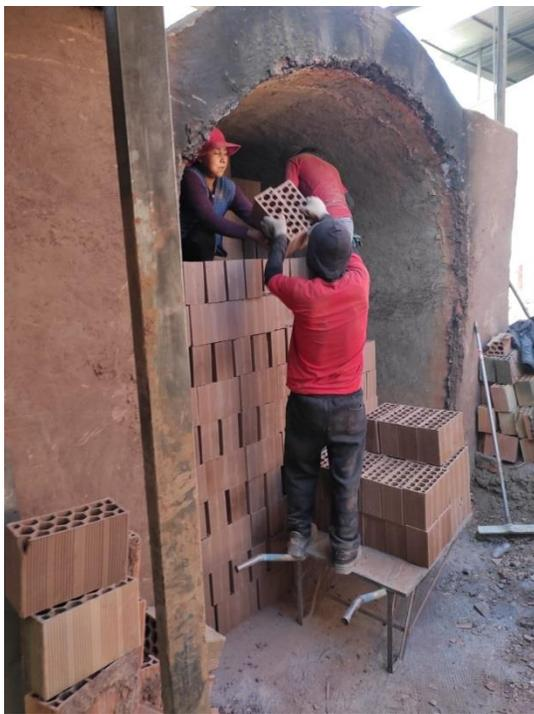
**Colocación de ladrillos para cocción en horno Paulista**
