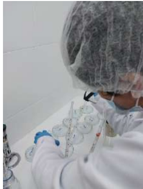
Figura 33 Inoculación de muestra y diluciones para el recuento de bacterias heterótrofas
