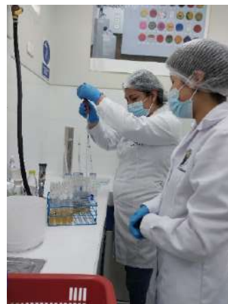
Figura 30 Inoculación de muestra en caldo lauril
