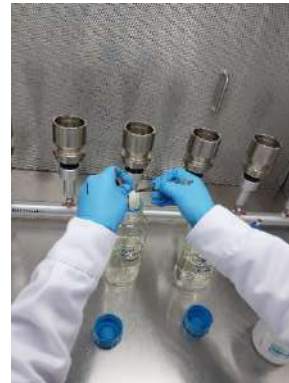
Figura 46 Incorporación del filtro PAD en agua peptonada
