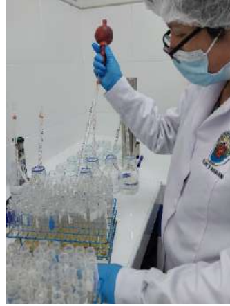
Figura 32 Inoculación de diluciones en caldo Lauril
