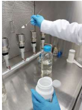
Figura 45 Incorporación tierra de diatomeas sobre filtro PAD
