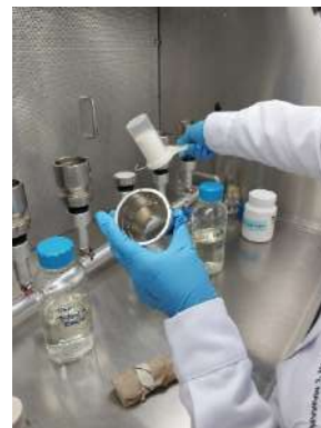
Figura 44 Colocación de filtro PAD en el equipo de filtración
