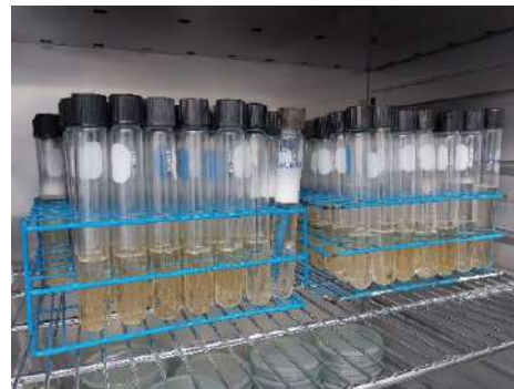
Figura 36 Incubación de tubos con caldo lauril y placas para bacterias heterótrofas
