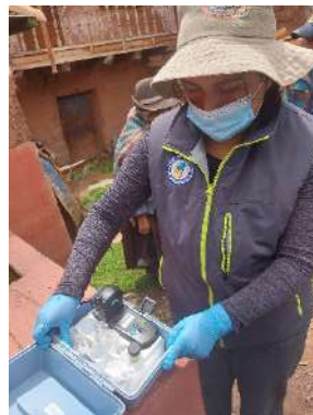
Figura 24 Determinación del cloro residual en la vivienda domiciliaria Jilanaca Rancho
