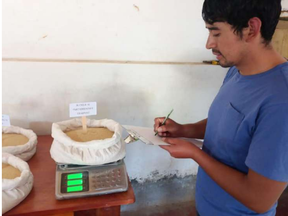
Fotografía 41. Pesado de grano de kiwicha en balanza de precisión
