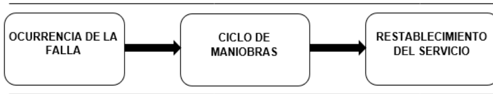
Figura 22: Ciclo de interrupción del servicio eléctrico
