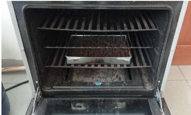
Foto N° 08. Muestra de Suelo en la estufa para el análisis de suelo
