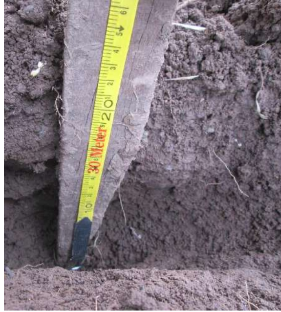
Foto N° 06. Profundidad de la muestra de suelo es 25 cm
