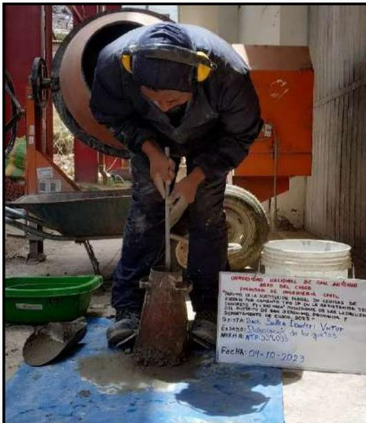
Fotografía 26: chuseado con la barrilla de 5/8" a la mezcla de concreto en el cono de Abrams.
