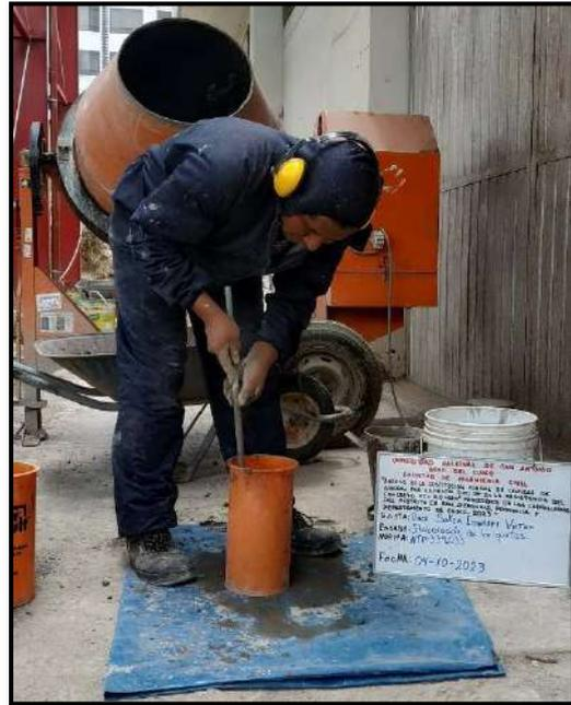
Fotografía 29: Chuseado 25 veces con varilla de 5/8 de la mezcla de concreto con 0% de ceniza de aserrín.
