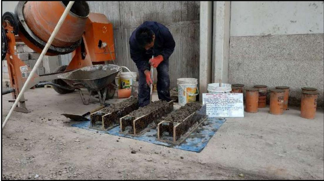
Fotografía 58: Elaboración de vigas de concreto por sustitución parcial del cemento con 12.5% de ceniza de aserrín
