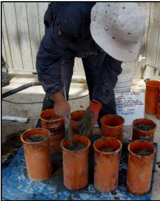
Fotografía 36: Chuseado de la mezcla de concreto 25 veces por capa, con varilla de 5/8"
