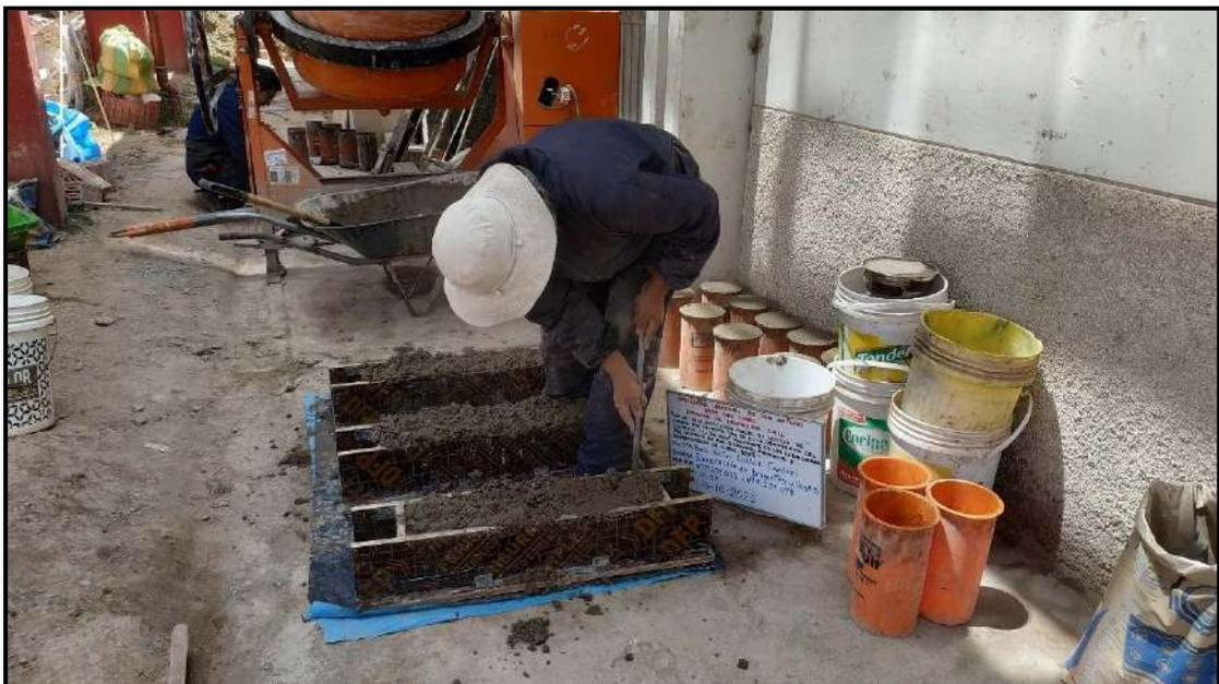
Fotografía 53: Elaboración de vigas de concreto con sustitución parcial del cemento con 10% de cenizas de aserrín
