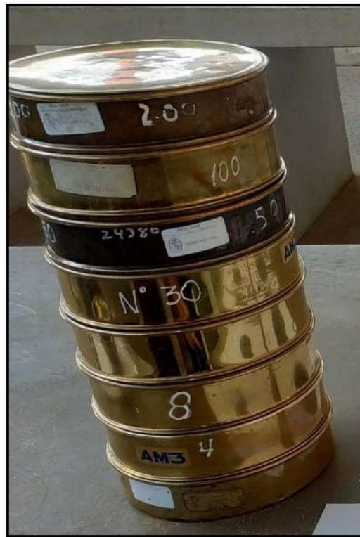
*Fotografía 7: juego de tamices utilizados según el huso N°67 para la granulometría del agregado fino*
