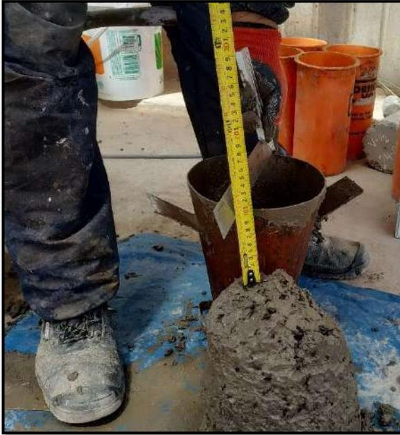
Fotografía 34: Medición del Slump de la mezcla de concreto con 2.5% de ceniza de aserrín.
