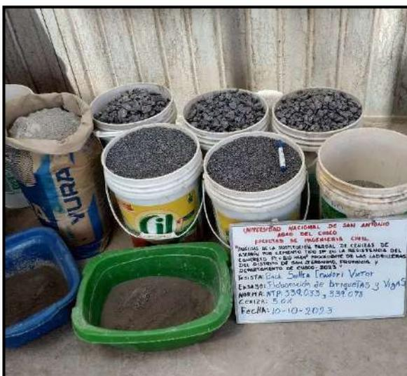
Fotografía 39: Materiales para el preparado de la mezcla de concreto con 5% de ceniza de aserrín.
