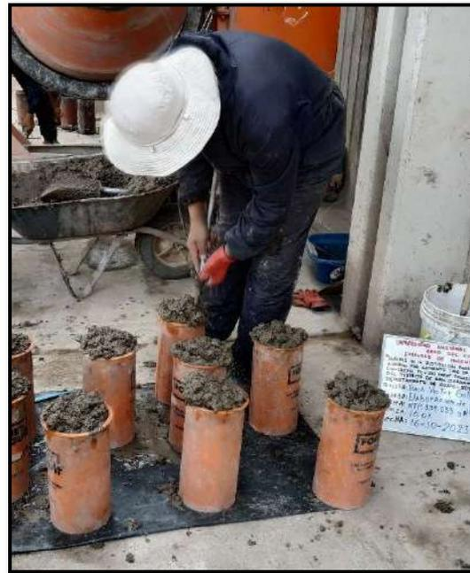
Fotografía 52: elaboración de briquetas con mezcla de concreto con 10% de cenizas de aserrín
