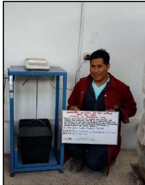
*Fotografía 17: Pesado del agregado grueso en estado saturado sumergido en agua*
