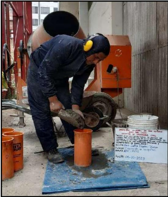
Fotografía 28: Llenado de la briquetera con mezcla de concreto con 0% de ceniza de aserrín.
