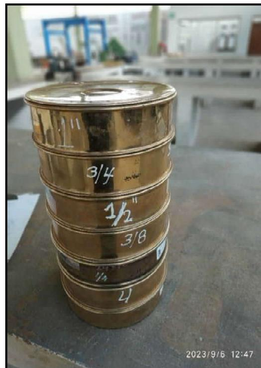
Fotografía 4: juego de tamices utilizados según el huso N°67 para la granulometría del agregado grueso
