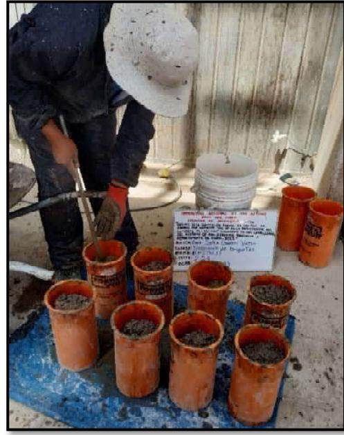
Fotografía 35: Llenado de las briquetetas con mezcla de concreto con 2.5% de ceniza de aserrín
