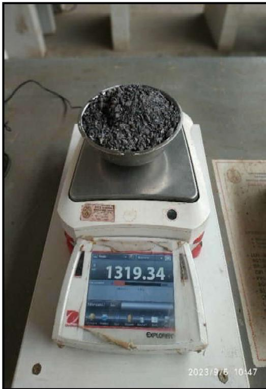
*Fotografía 6: Fotografía 3: Pesado del agregado fino para el tamizado*
