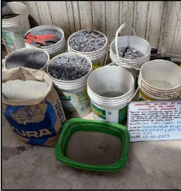
Fotografía 44: Materiales para la elaboración de la mezcla de concreto con 7.5% de ceniza de aserrín
