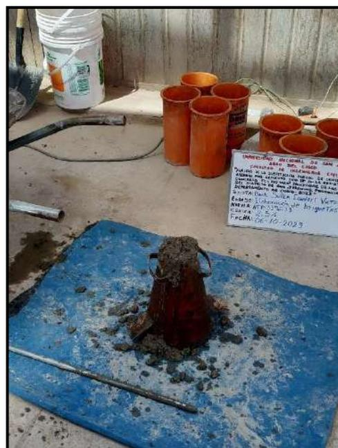
Fotografía 33: Llenado del cono de Abrams con mezcla de concreto con 2.5% de ceniza de aserrín
