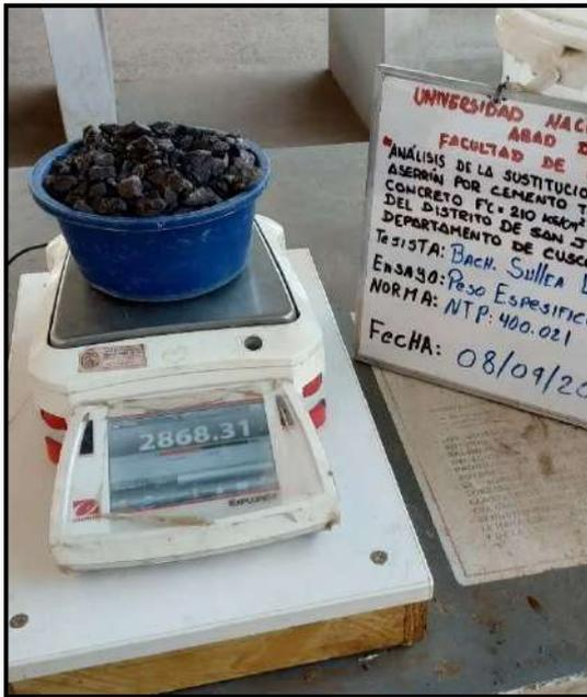
*Fotografía 16: Pesado del agregado grueso en estado saturado superficialmente seca*
