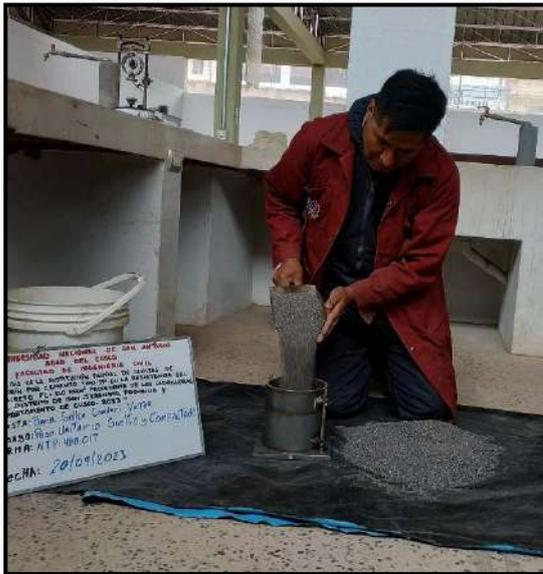
Fotografía 13: Llenado del molde de Proctor modificado con agregado fino.
