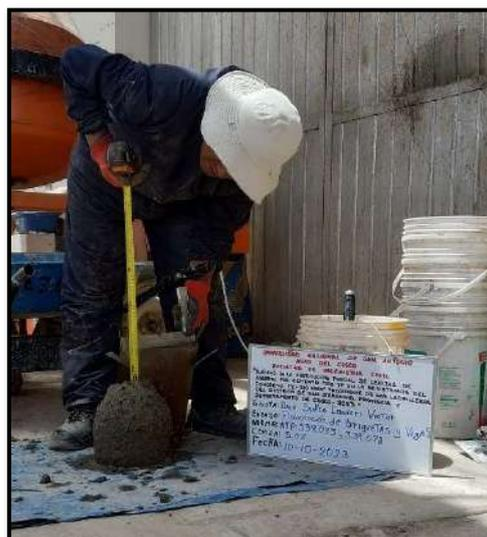
Fotografía 40: medición del slump de la mezcla de concreto con 5% de ceniza de aserrín.
