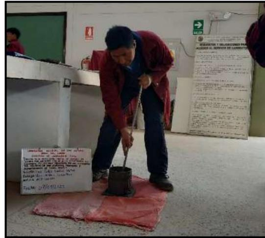
*Fotografía 10: Chuseado del agregado grueso para el acomodamiento del material en el molde del Proctor modificado para la determinación del peso unitario compactado*
