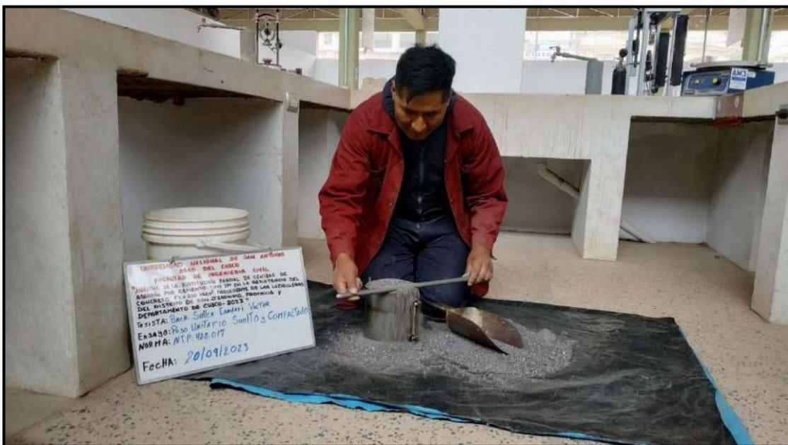
Fotografía 15: Emparejado del agregado fino en el molde de Proctor modificado
