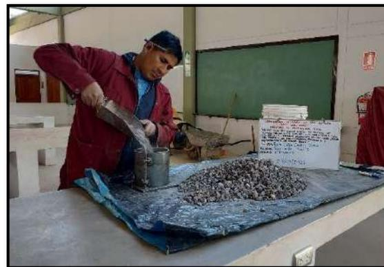
*Fotografía 12: Colocado por caída libre del agregado grueso en el molde del Proctor modificado para la determinación del peso unitario suelto*
