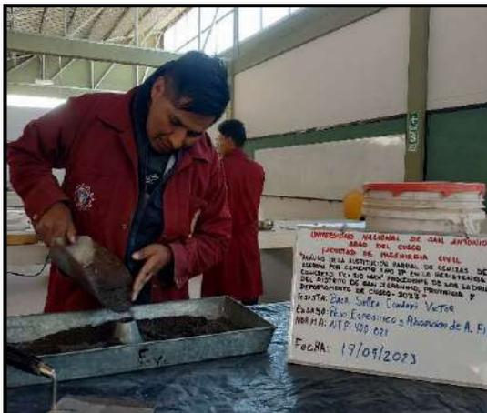
Fotografía 22: llenado del molde metálico con agregado fino
