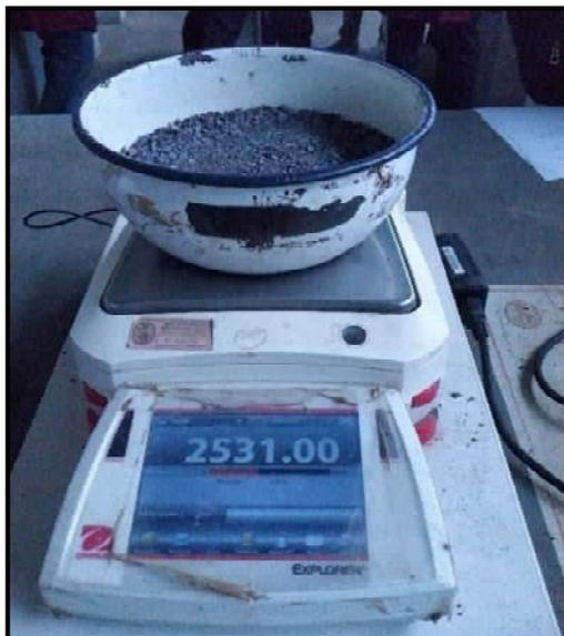
*Fotografía 18: control de peso del agregado fino secado al horno después de 24 horas*
