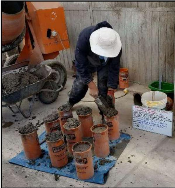
Fotografía 61: Elaboración de briquetas con mezcla de concreto con 15% de ceniza de aserrín
