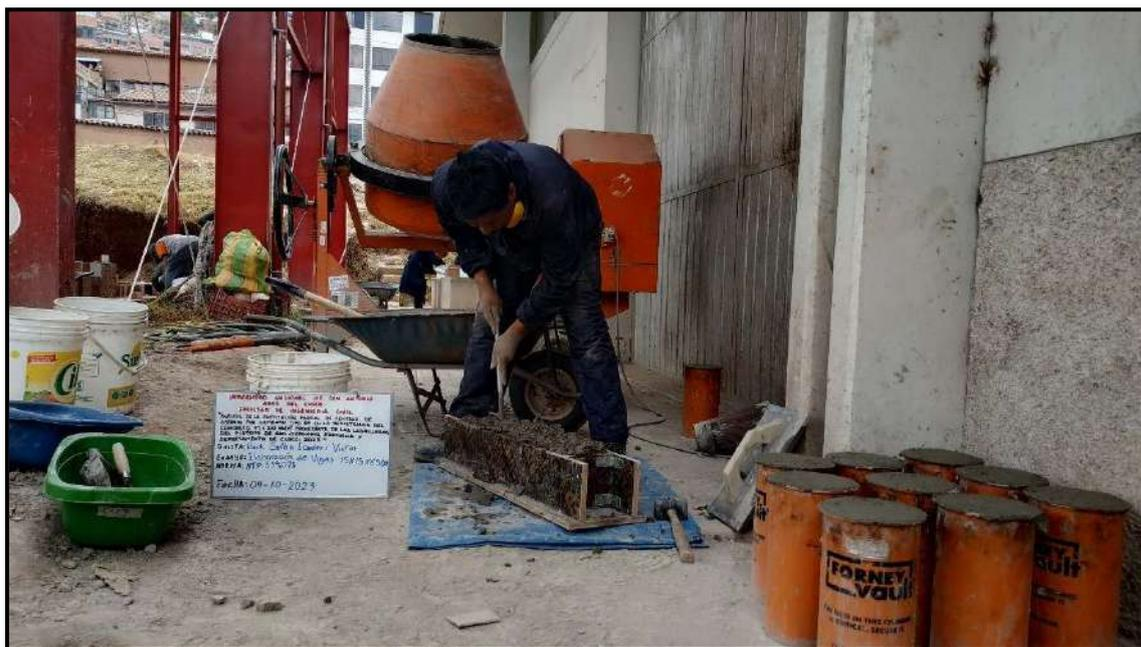
Fotografía 31: Elaboración de la viga de concreto con 0% de ceniza de aserrín según la norma NTP 339.078
