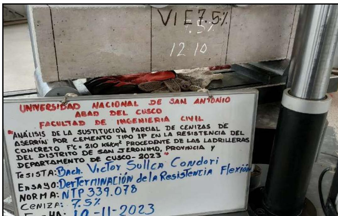
Nota: cómo se puede apreciar en la figura el daño está ubicado dentro del tercio central de la viga de hormigón con un contenido del 7.5% de ceniza de aserrín.
