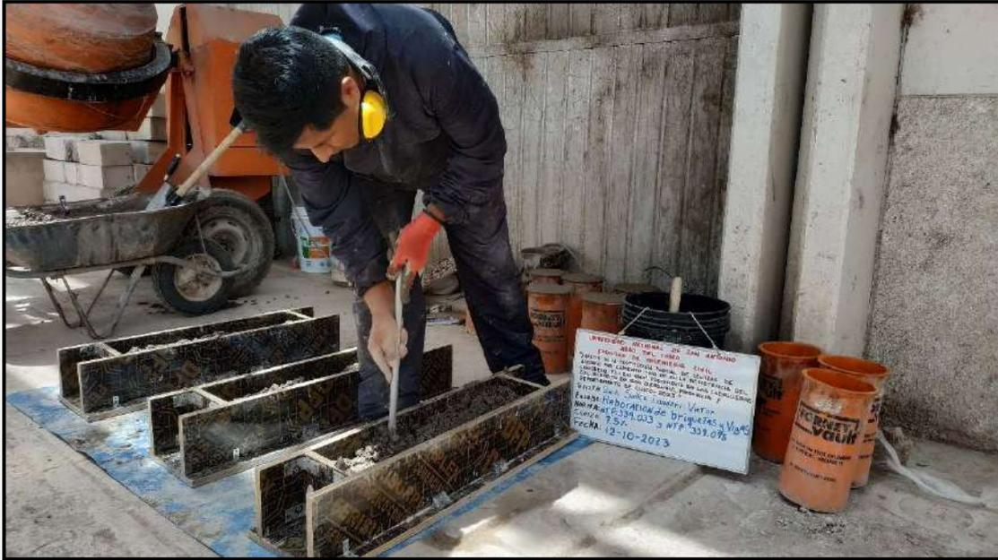
Fotografía 48: Elaboración de vigas de concreto con sustitución parcial del cemento con 7.5% de cenizas de aserrín
