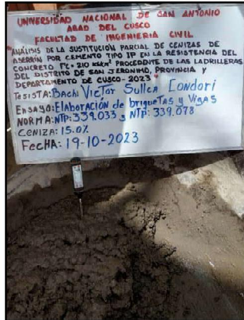
Fotografía 62: Control de temperatura de la mezcla de concreto con 15% de ceniza de aserrín
