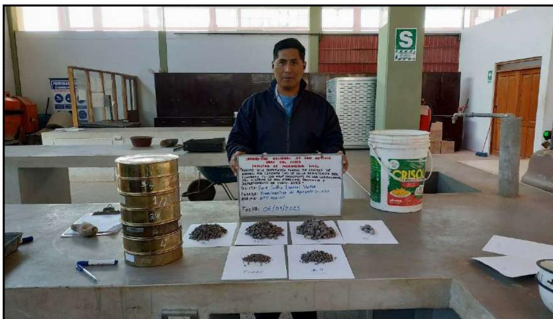
Fotografía 5: Agregados retenidos en los tamices según la abertura del número correspondiente.
