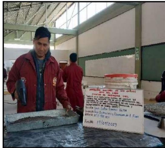
Fotografía 21: secado del agregado fino hasta obtener un agregado saturado superficialmente seco (SSS)
