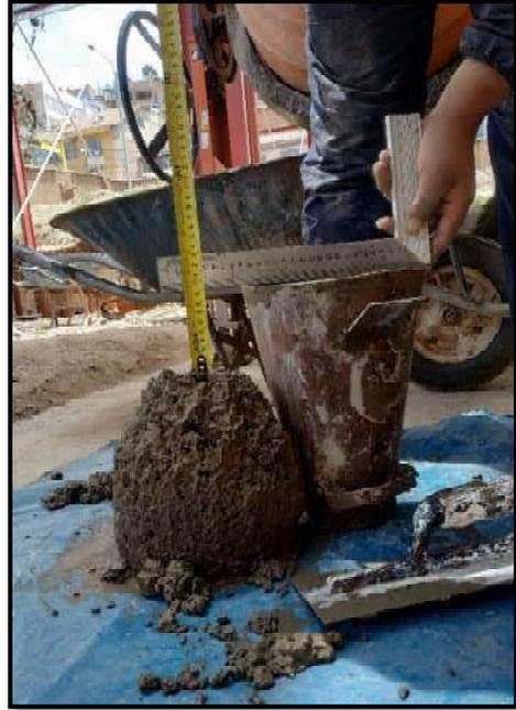
Fotografía 45: medición del slump del concreto con 7.5% de ceniza de aserrín
