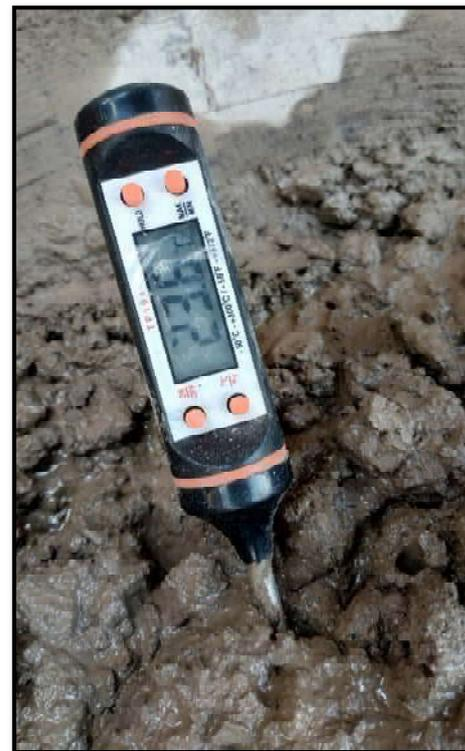
Fotografía 37: control de temperatura de la mezcla de concreto con 2.5% de ceniza de aserrín
