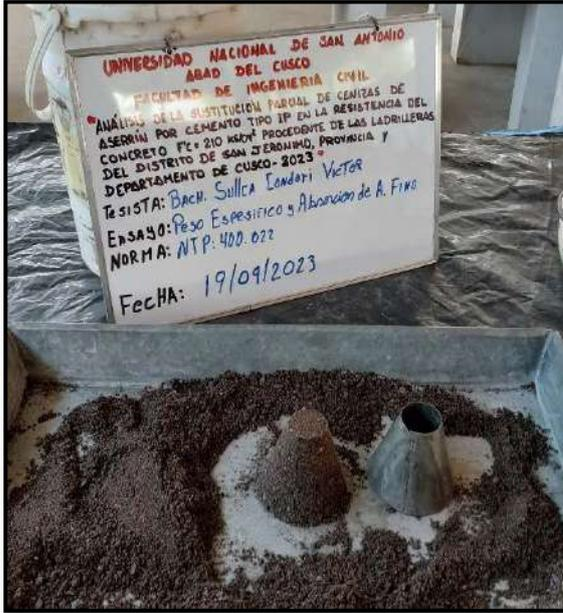
Fotografía 24: se observa que el agregado fino aún no se encuentra en estado saturado superficialmente seco por lo que se tendrá que seguir secando hasta obtener el agregado en estado SSS.
