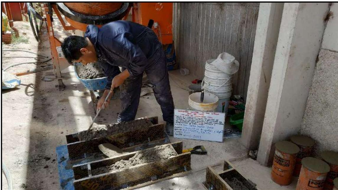
Fotografía 43: Elaboración de vigas de concreto con sustitución parcial del cemento con 5% de ceniza de aserrín.
