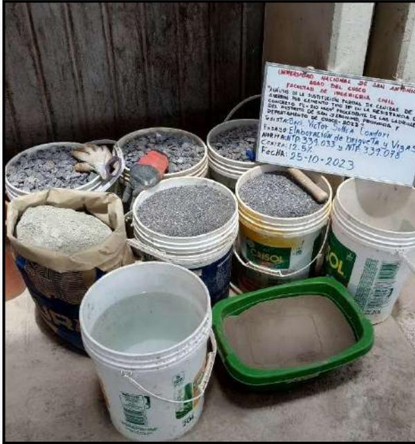
Fotografía 54: Materiales requeridos para la elaboración del concreto con 12.5% de ceniza de aserrín
