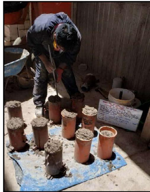
Fotografía 42: Elaboración de briquetas con mezcla de concreto con 5% de cenizas de aserrín
