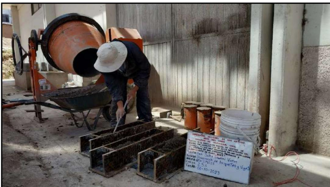
Fotografía 38: Elaboración de vigas de concreto con 2.5% de sustitución parcial del cemento por ceniza de aserrín.
