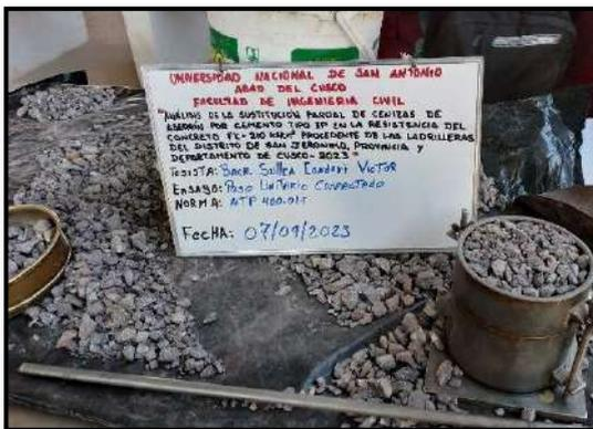
*Fotografía 11: Emparejado del agregado grueso en el molde del Proctor modificado para la determinación del peso unitario compactado*
