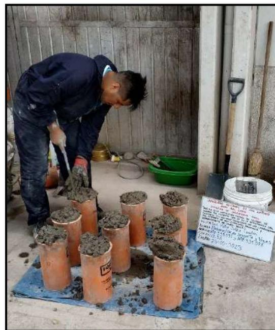
Fotografía 57: Elaboración de briquetas de concreto con 12.5% de ceniza de aserrín
