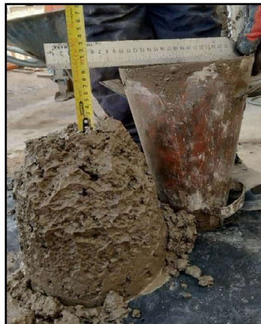
Fotografía 50: Control del slump para la mezcla de concreto con 10% de ceniza de aserrín
