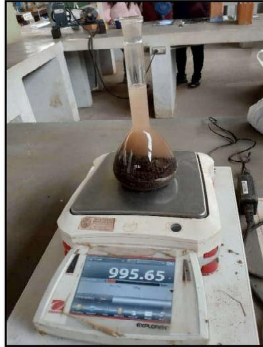
Fotografía 25: control de peso de la fiola más agua más agregado fino saturado superficialmente.
