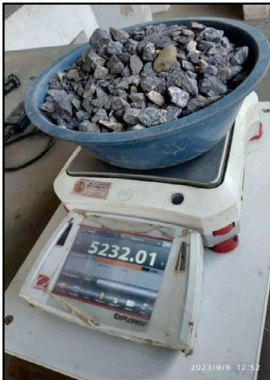
Fotografía 3: Pesado del agregado grueso para el tamizado
