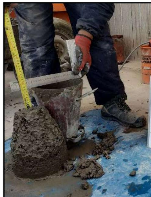
Fotografía 60: Control del Slump para la mezcla de concreto con 15% de ceniza de aserrín
