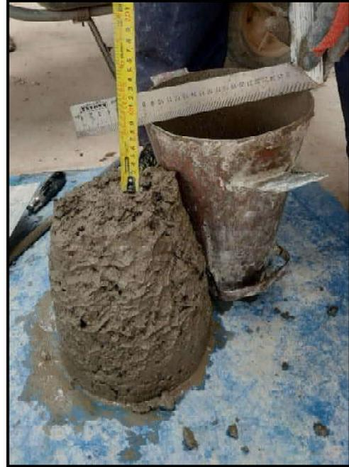
Fotografía 55: Control del slump para la mezcla de concreto con 12.5% de ceniza de aserrín
