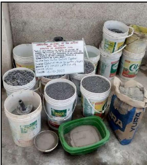
Fotografía 49: Materiales a utilizar para el preparado de mezcla de concreto con 10% de ceniza de aserrín
