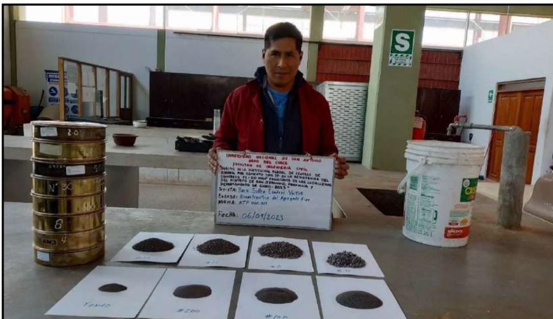
*Fotografía 8: Agregados retenidos en los tamices según la abertura del número correspondiente.*
