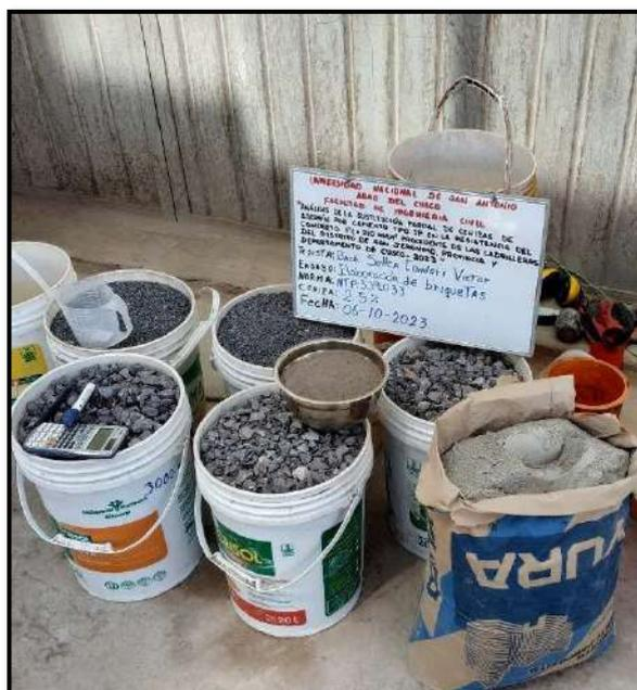
Fotografía 32: Materiales a utilizar para la mezcla de concreto con 2.5% de ceniza de aserrín
