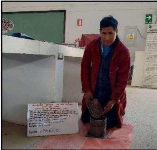
*Fotografía 9: Colocado del agregado grueso en el molde del Proctor modificado antes del chuseado con la barrilla lisa de 5/8"*
