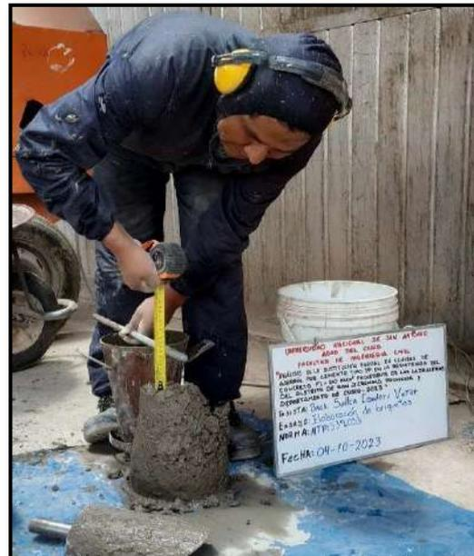
Fotografía 27: Medición de la mezcla de concreto para la comprobación del slump en la mezcla de concreto.
