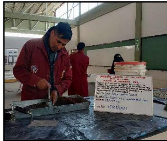
Fotografía 23: Compactado del agregado fino en el cono metálico para comprobar si se encuentra en estado saturado superficialmente seco.
