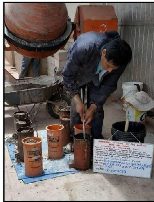
Fotografía 47: Elaboración de briquetas de concreto con 7.5% de ceniza de aserrín
