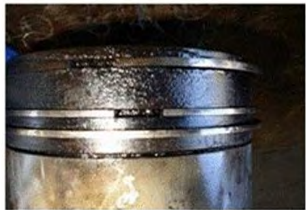
Pistón con: carbón, lacas, barnices y corrosión
