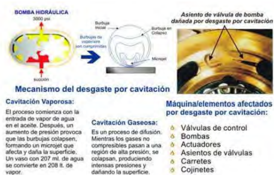
Figura 24 Mecanismo por desgaste por cavitación.
