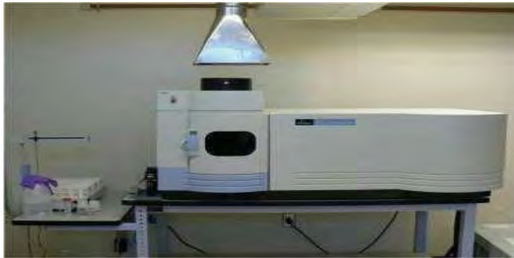
Figura 52 Equipo de plasma IPC Fuente: Ferreyros 2019 laboratorio. SOS
