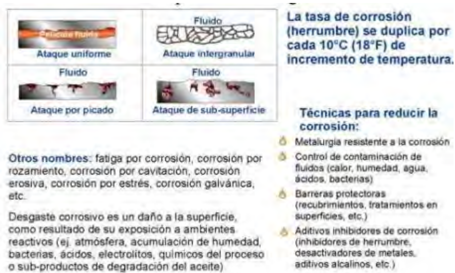
Figura 22 Mecanismo de desgaste por corrosión
