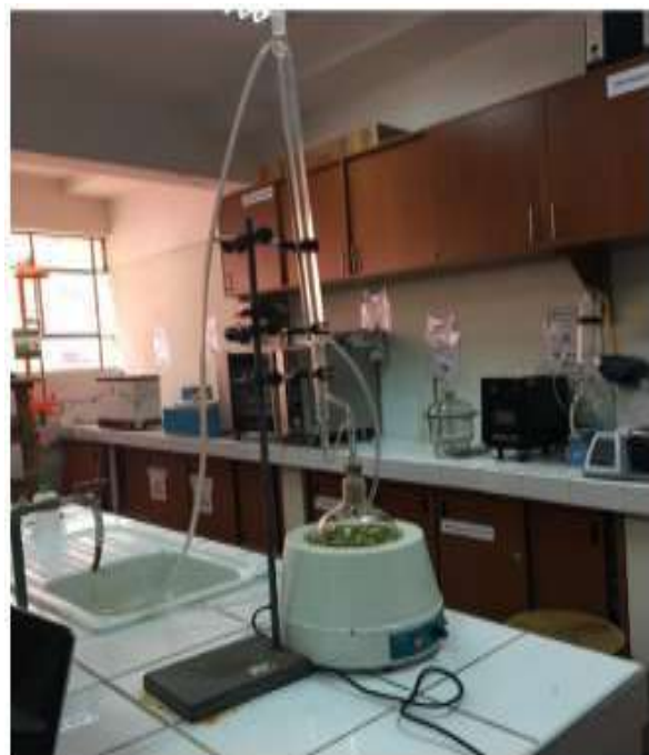
Fotografía 4. Equipo de destilación por Clevenger
