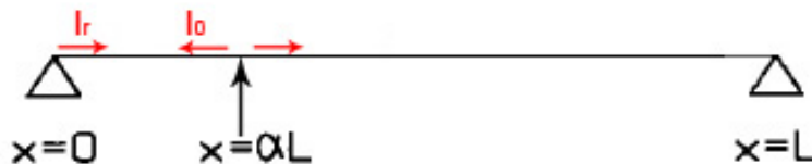
Figura 2.9: Ondas generadas por el golpe del martillo.
