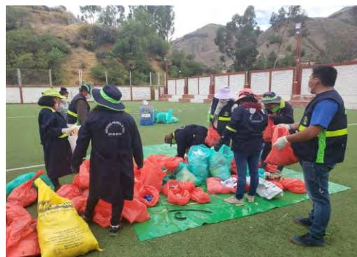
**Foto 18** *Procedimiento para determinar la composición física de los residuos sólidos.*
