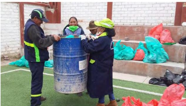
**Foto 17** *Procedimiento para determinar la densidad*
