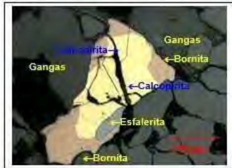
Bornita asociada con calcopirita y esfalerita en gangas.
