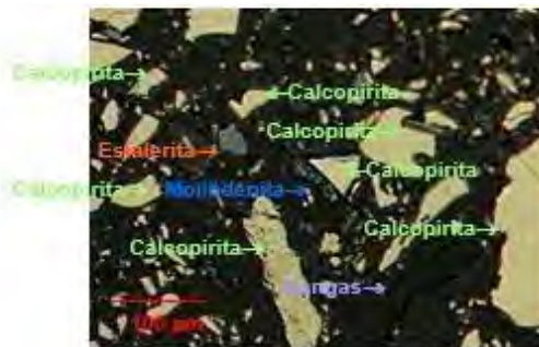
Partículas libres de calcopirita y esfalerita. Calcopirita con bordes de molibdenita.
