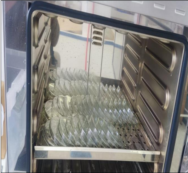
Figura N°1: en la figura se observa ingreso de las placas Petri a la estufa para su debida esterilización a una temperatura de 100 °C. fuentes propia
