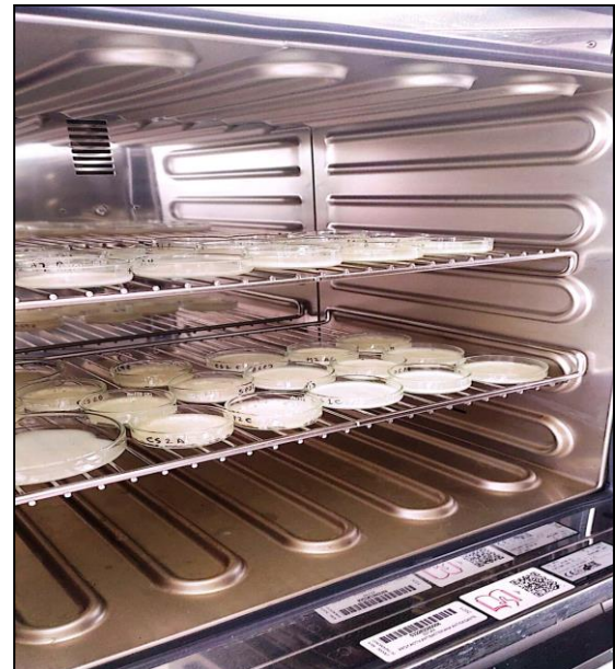
Figura N°36: Se observa las placas con muestra en la estufa para el secado a una temperatura no mayor a 80 °C. Fuente propia
