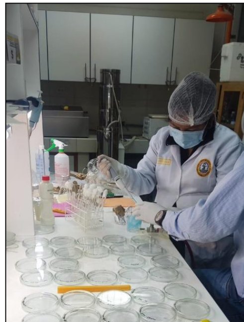
Figura N°18: Se observa el sembrado de la muestra en las placas esterilizadas y rotuladas. Fuente propia
