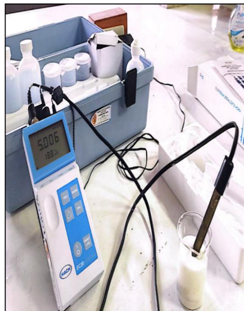
Figura N°44: Se observa la calibración del pH metro electrónico. Fuente propia
