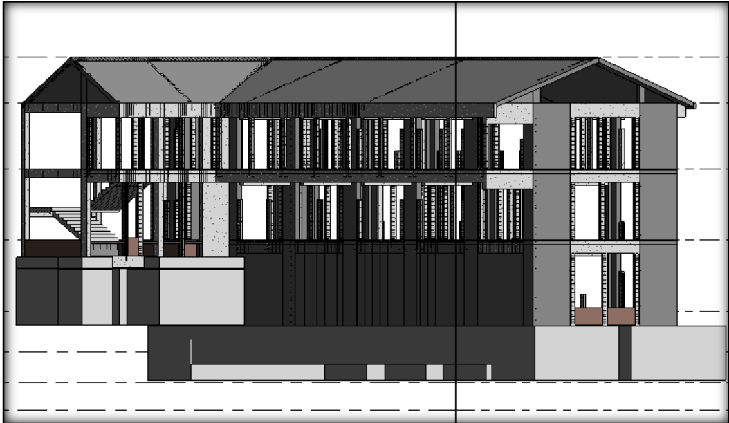
Figura 22: Distribución de elementos estructurales en el bloque E Y F Fuente: REVIT – Elaboración Propia
