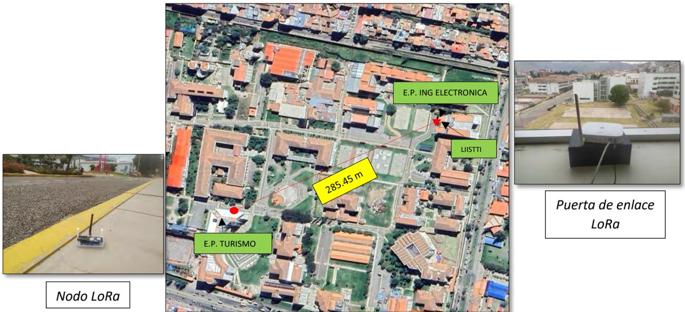
*Figura 3.5 Ubicación de la red para pruebas experimentales por interferencia co-canal*
