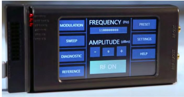
*Figura 3.4 Generador de señales ERASynth Micro*
