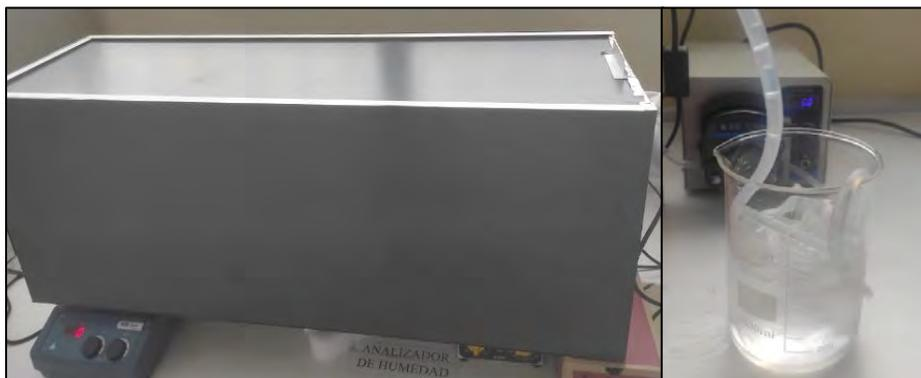
*Nota.* En el lado izquierdo, se muestra la configuración que comprende el sistema reflectante montada sobre dos agitadores magnéticos. Mientras que, en el lado derecho, se muestra el sistema de enfriamiento que es controlado mediante una bomba peristáltica.
