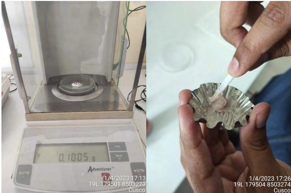
Nota. En el lado izquierdo se lleva a cabo la medición de la masa del catalizador  $\text{TiO}_2$ , mientras que en el lado derecho se procede con la amalgamación del catalizador con el monómero y polímero, dando lugar a la formación de una estructura esférica.
