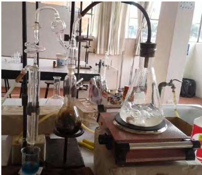
*Nota.* Equipo Kjeldahl para la determinación de proteína.
