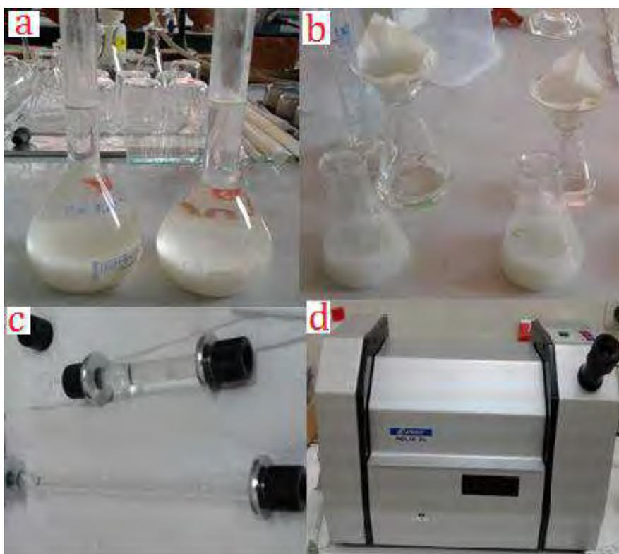
*Nota.* Precipitación de leche con ácido tungsténico(a), filtración del material precipitado (b), tubos porta muestra(c) y polarímetro (d).
