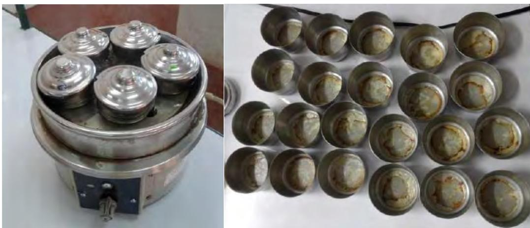
Nota. Cápsulas en baño maría (izquierda), capsulas después del secado (derecha).
