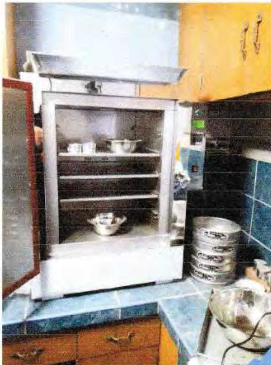
SECADO DE MUESTRAS EN LOS DIFERENTES ENSAYOS
