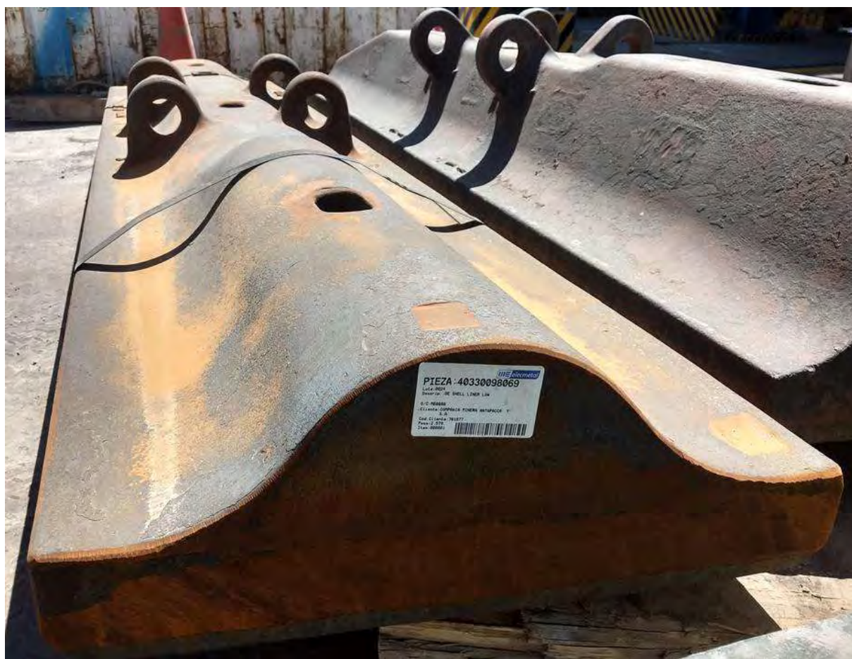
Figura 18. Dos revestimientos del casco del molino SAG, esperando ser montados.
