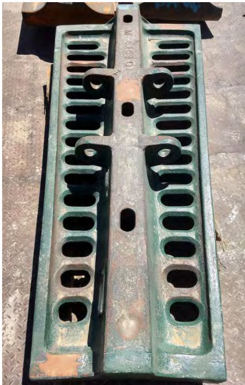
Figura 19. Parrilla de la tapa de descarga del molino Sag esperando ser montado.
