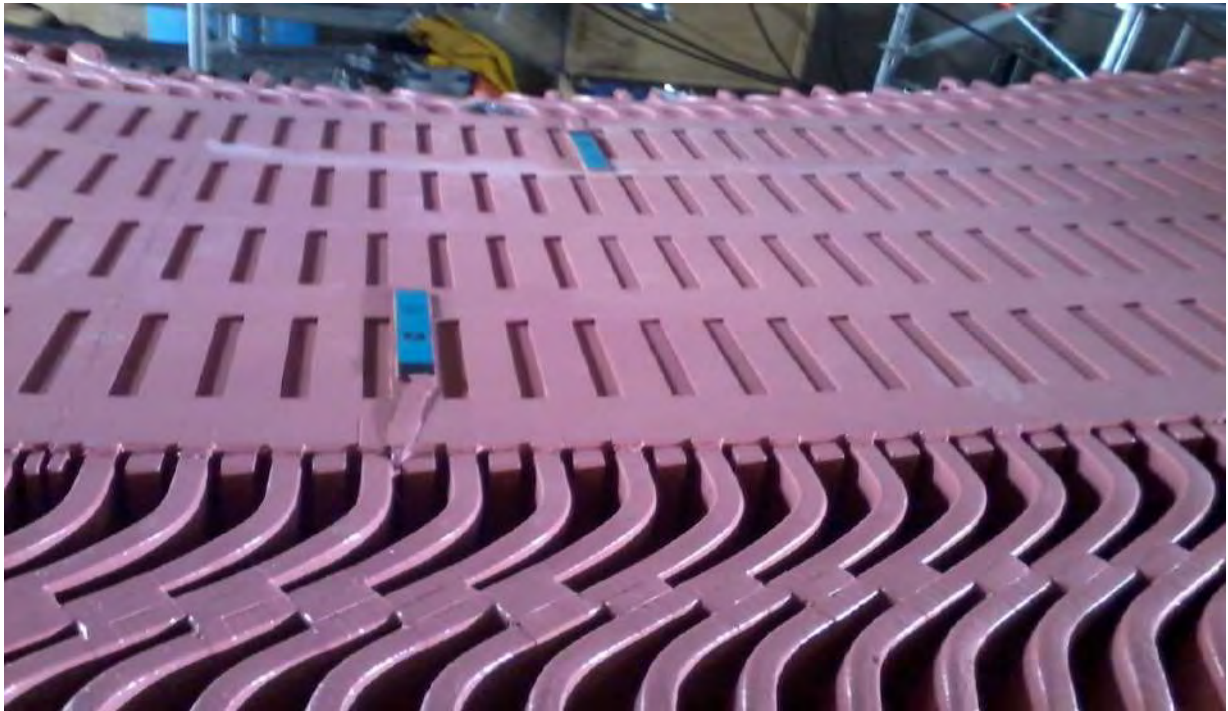
Figura 36. Sensores de entrehierro VM 3.1 en la marca Vibrosystem
