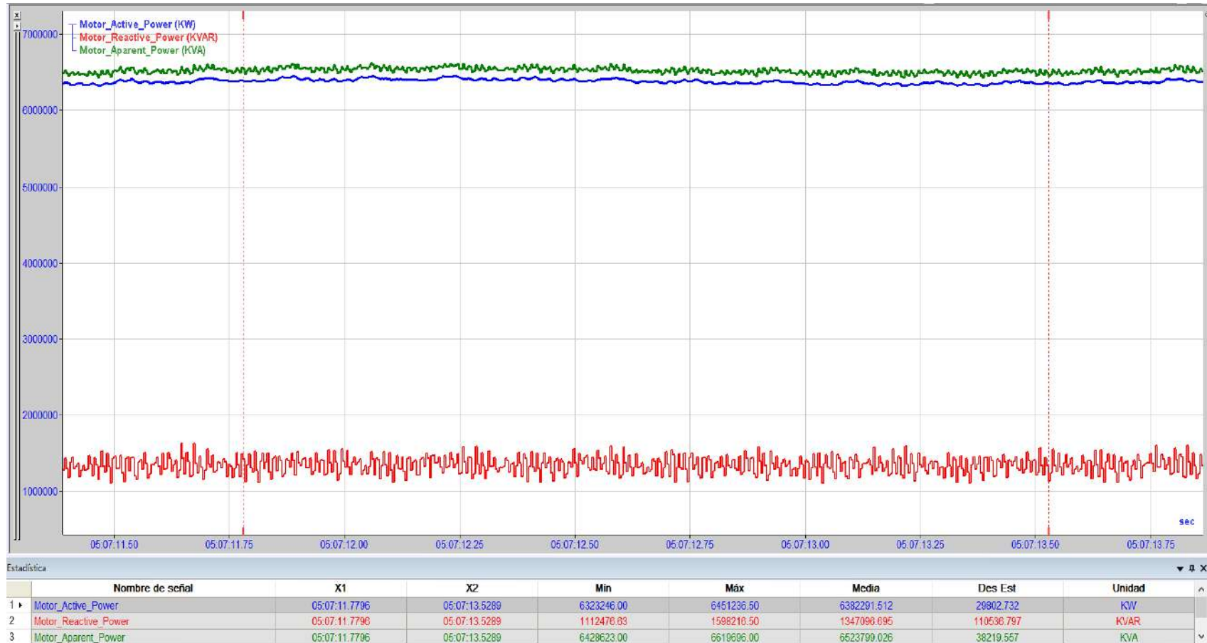
Figura 53. Potencias de un motor síncrono de 24 MW.
