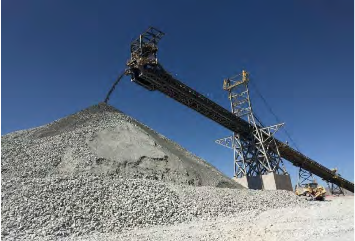
Figura 7. Faja transportadora Overland alimentando a la ruma de gruesos.
