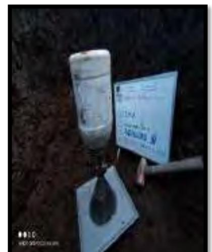
Fotografía 6: Ensayo in situ de densidad de suelo, C-02
