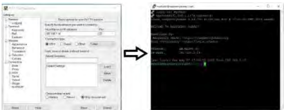
Figura 64: Acceso a la terminal del Raspberry Pi a través de PuTTY.
