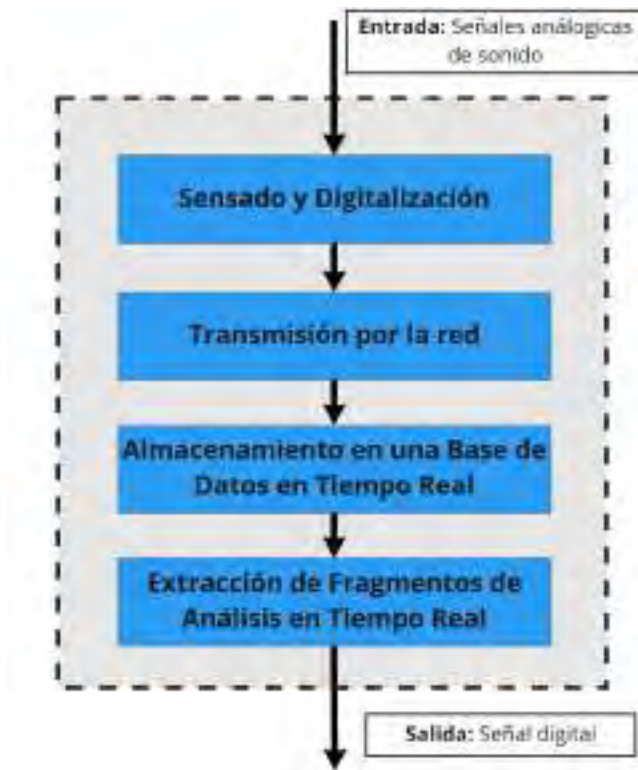
Figura 53: Arquitectura del módulo de acondicionamiento de señal para procesamiento en tiempo real.
