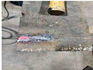
Probeta con canal de corte
