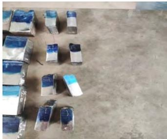
Probeta (DC) para prueba de dureza
