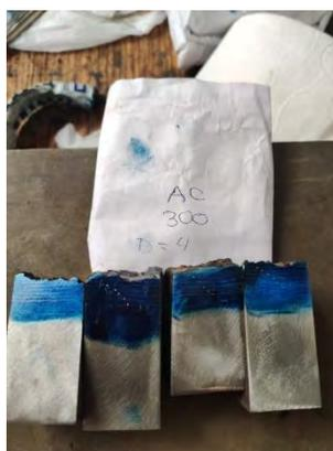
Realizando prueba de dureza
