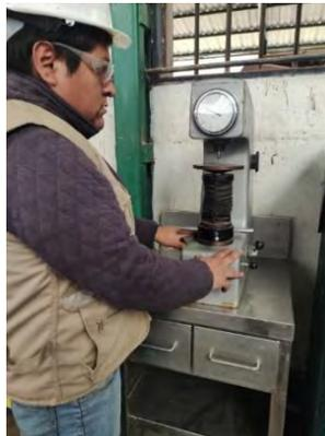
Indentador del durómetro
