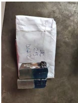
Probeta (AC) para prueba de dureza
