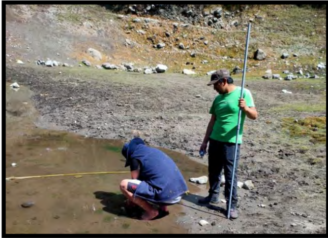
Anexo 10: Medición de la transparencia con el Disco Secchi
