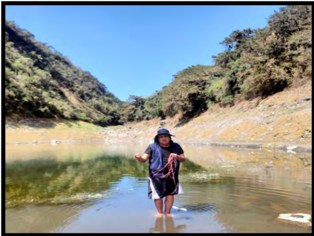
Anexo 10: Medición de la transparencia con el Disco Secchi
