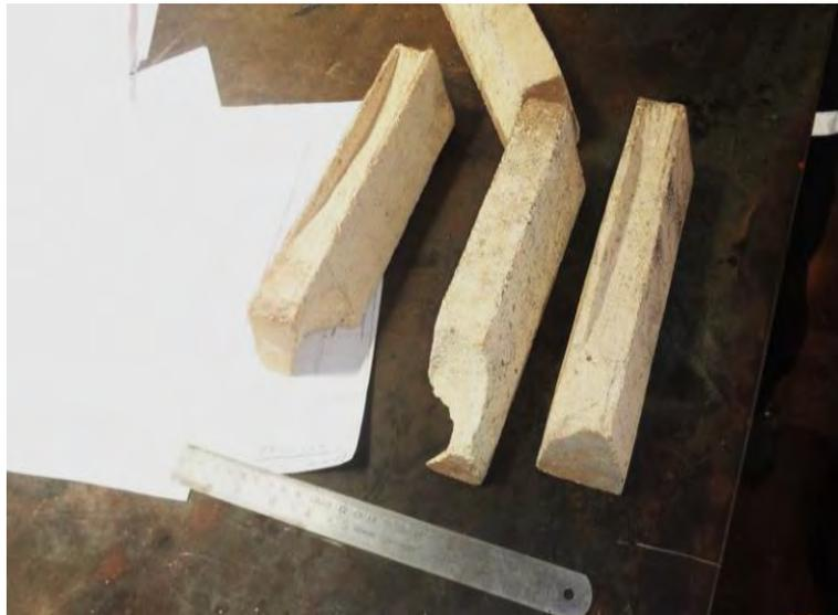
Los ladrillos tallados son 06 según el diseño y otro ladrillo es tallado con un corte circular para la entrada de la tobera del quemador
