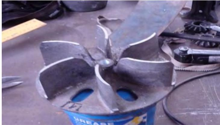
El armado del quemador se concluye fijando tobera con la turbina armada, esto resulta que el quemador será montado en el motor en un solo componente y con esta modificación el quemador no se desacopla y se moverá junto con el horno cuando realice el basculamiento para descargar la carga fundida de metal, entonces el horno estará en funcionamiento continuo porque el suministro de gas no se cierra y motor eléctrico funciona.
