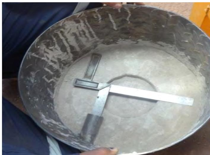
Determinado la posesión de la tobera se fija con soldadura a la estructura metálica de la cámara y luego se le coloca el crisol para ubicar su posición con respecto a la tobera, el punto de inicio para colocar y posicionar los ladrillos será la tobera del quemador.
