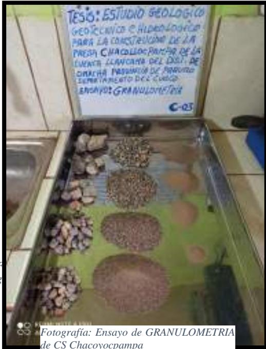
Fotografía: Ensayo de GRANULOMETRIA de CS Chacoyocpampa
