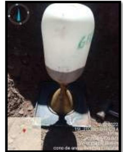
Fotografía: Ensayo in situ de densidad de
