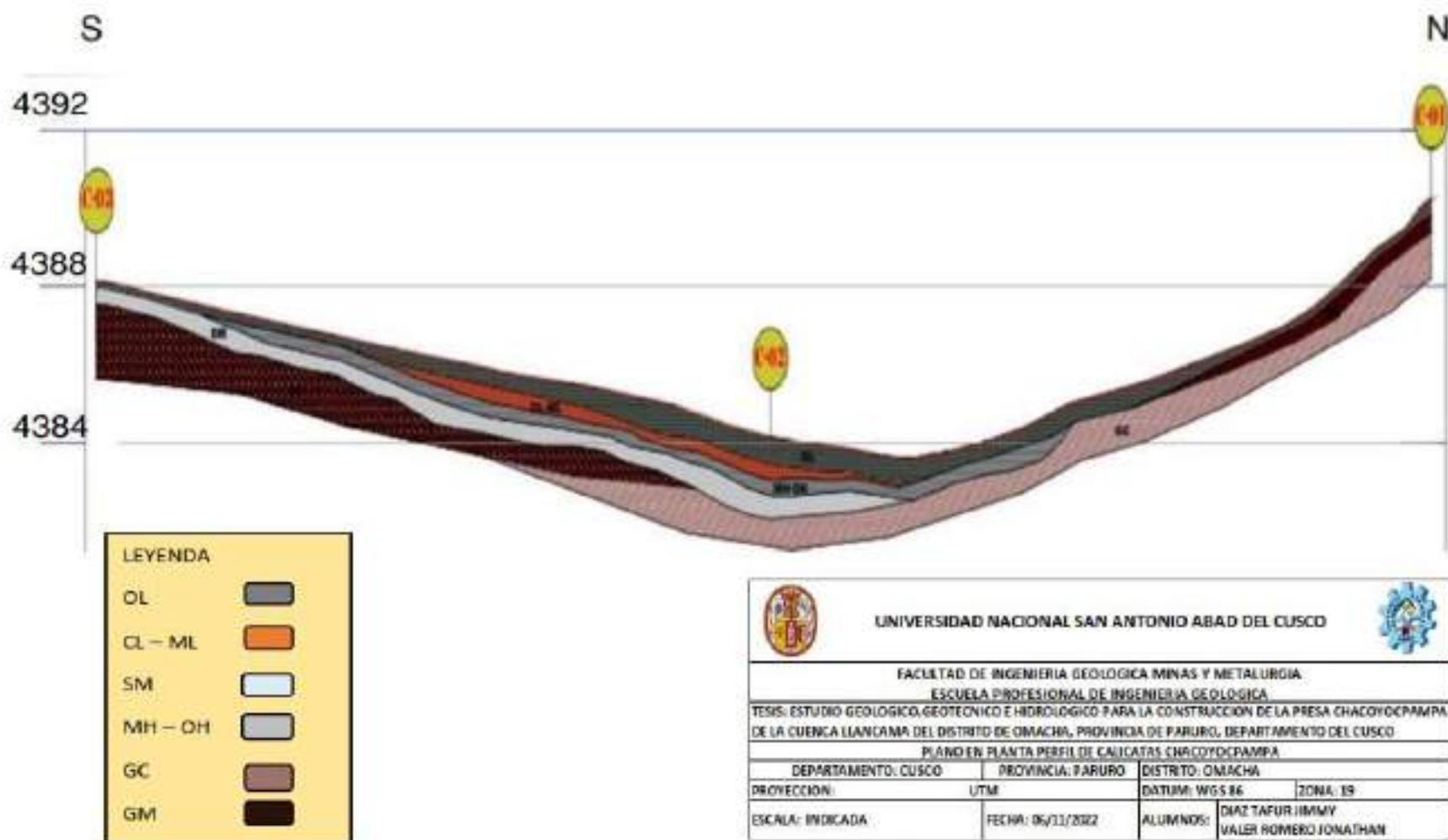
Figura 28 Perfil estratigráfico del eje de presa, Chacoyocampampa
