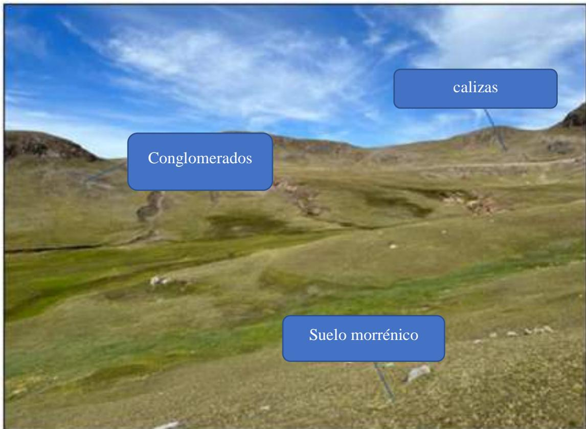
*Fotografía 4 Afloramiento de Conglomerado, Vista de la zona de presa, observando afloramiento de suelos cuaternarios y macizo rocoso, circundante al área de interés en estudio*
