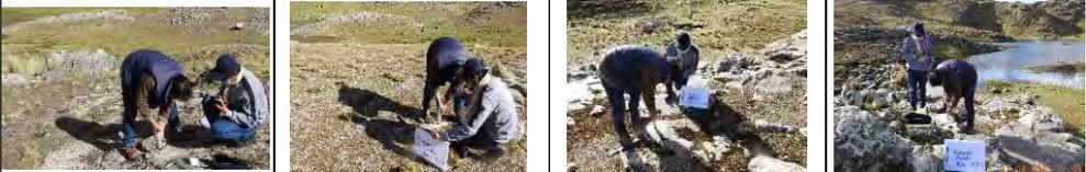
Para hallar el valor de compresión simple a partir de los 10 ensayos en cada uno de los puntos, se ha tomado como dato de la densidad de la roca obtenida (27kN/m<sup>2</sup>) a partir de su masa y volumen de los testigos de perforación obtenidos, con valores promedio se tiene valores entre 125Mpa y 130Mpa, valores que han sido utilizados en la valoración del macizo rocoso.
