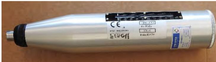
*Figura 52. Esclerómetro de rocas utilizado en los ensayos*
