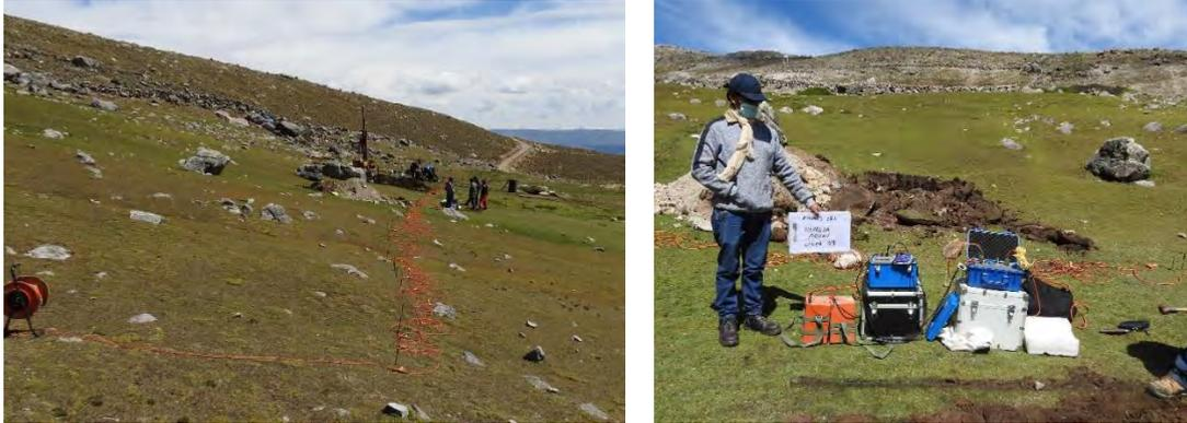
*Figura 59. Línea de tomografía eléctrica de la sección D-D' en proceso de instalación de los electrodos y registro*
