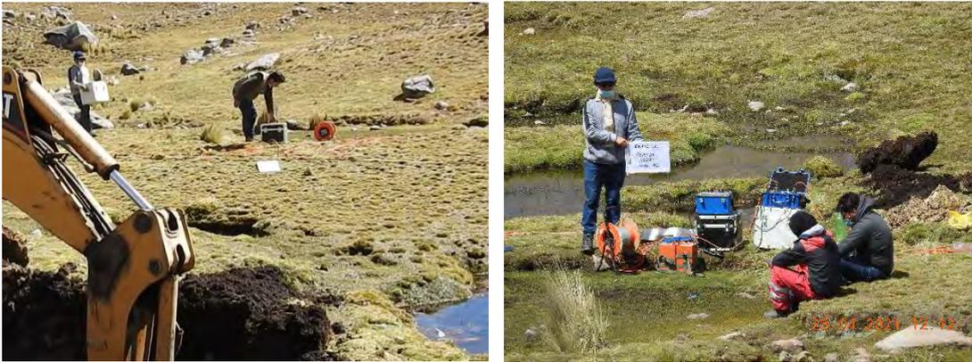
*Figura 57. Línea de tomografía eléctrica de la sección B-B' en proceso de instalación de los electrodos y registro*
