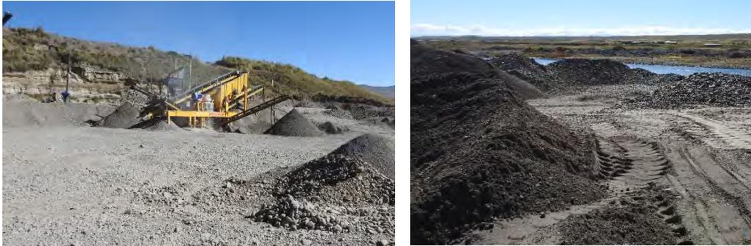
*Figura 81. Cantera del puente Coporaque en el que se producen agregados para concreto*
