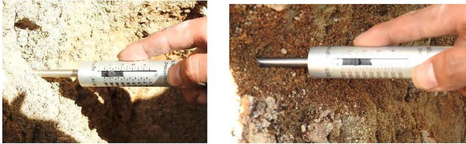
*Figura 54. Capacidad portante admisible en nivel de delgados estratos de suelos arenoso de las morrenas mediante el penetró metro de Pocket.*
