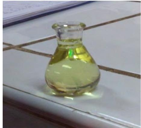
**Foto N° 09:** Determinación de la densidad del AE mediante un picnómetro.
