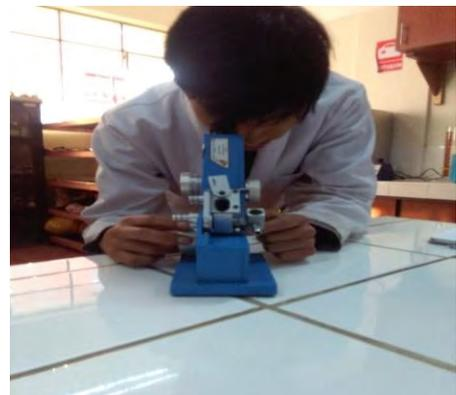
**Foto N° 11:** Medición del índice de refracción del AE mediante el refractómetro ABBE.
