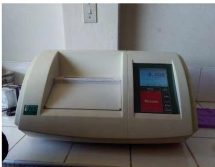
**Foto N° 12:** Medición de la rotación óptica mediante un polarímetro
