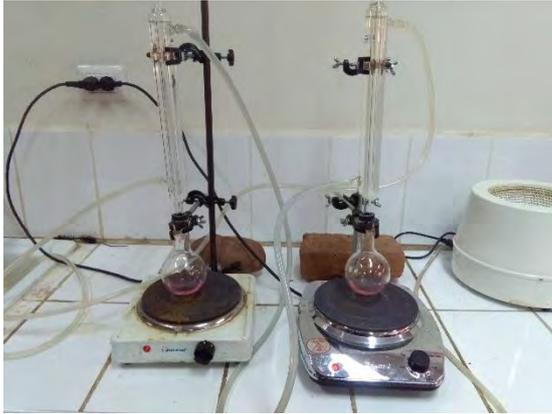
**Foto N° 14:** Medición del índice de saponificación, proceso de ebullición y reflujo.
