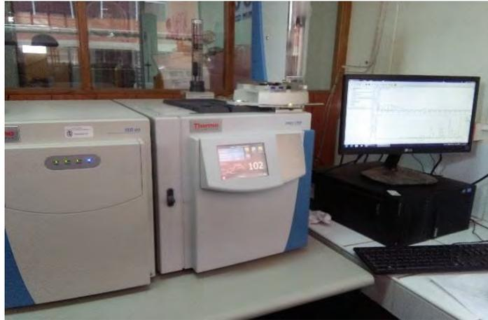
**Foto N° 18:** Determinación de la composición química mediante CG-MS, temperatura inicial a 60°C
