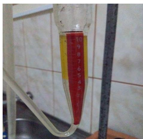
**Foto N° 07:** Obtención del aceite esencial medido con la escala de Clevenger
