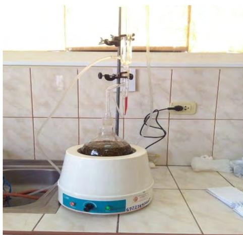
**Foto N° 06:** Proceso de extracción del aceite con el método de Hidrodestilación.
