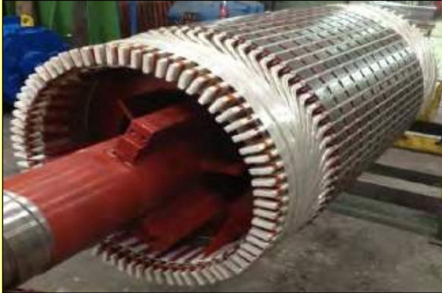
Figura 2.13: Rotor cilíndrico o sin saliencia.
