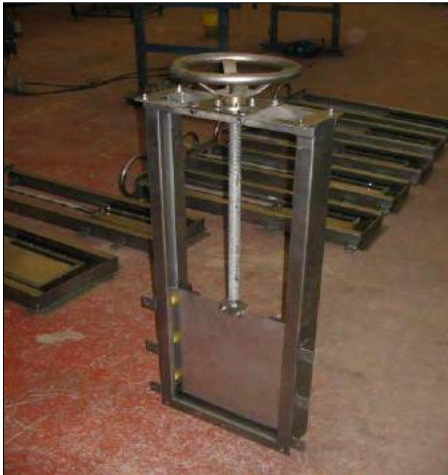
Figura 3.16: Compuertas deslizables
