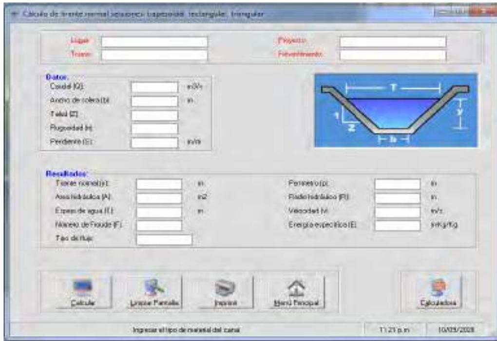
Figura 4.3: Pantalla principal del Software H-Canales
