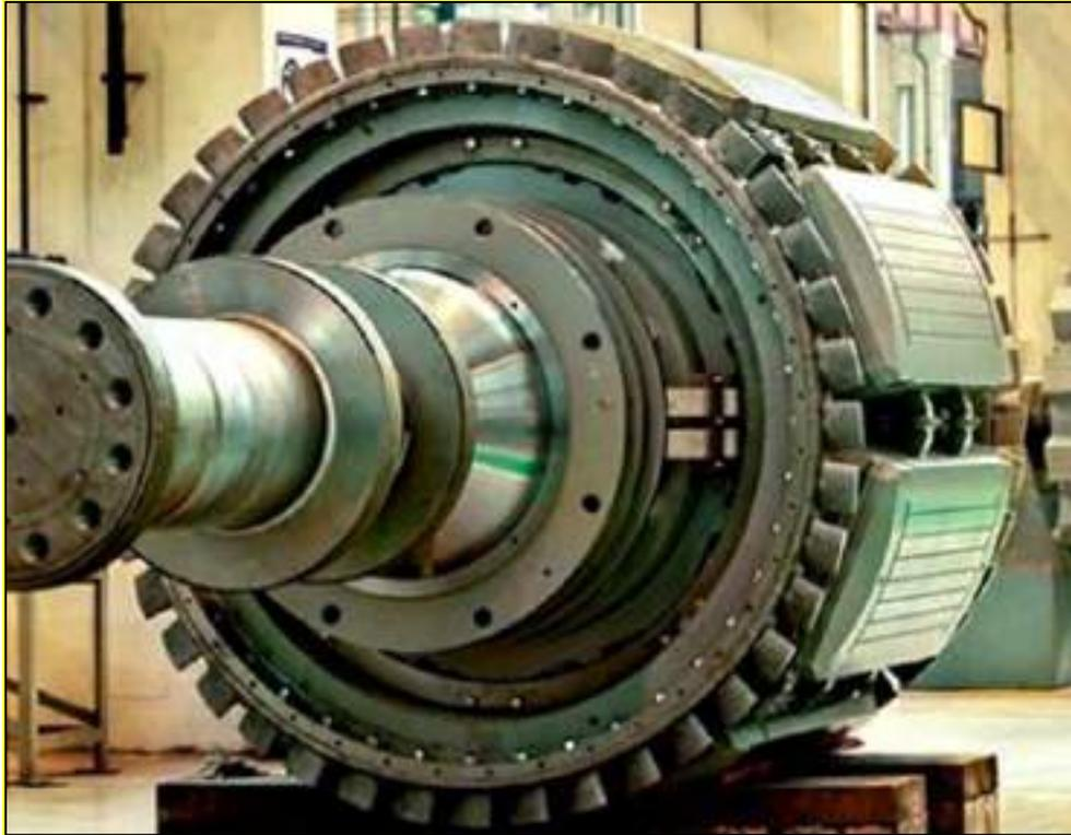
Figura 2.15: Rotor de polos salientes.
