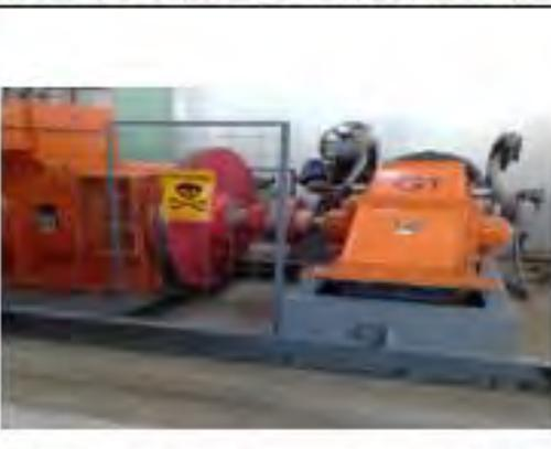
Vista que muestra la malla anterior y reemplazado con malla nueva construido para la protección de volante de inercia de los Grupos G1 y G2
