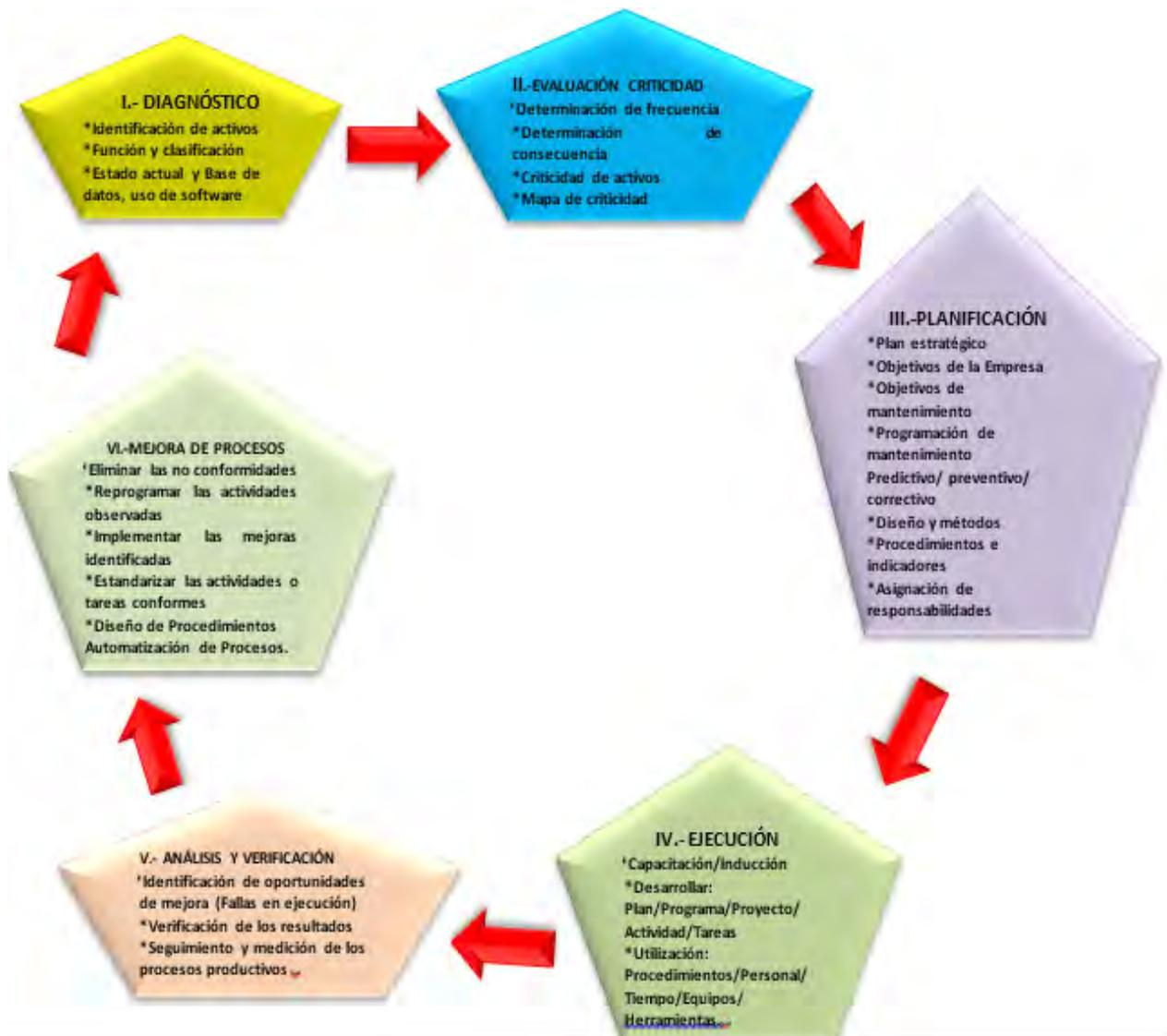
Figura 5.4: Esquema de propuesta de mantenimiento
