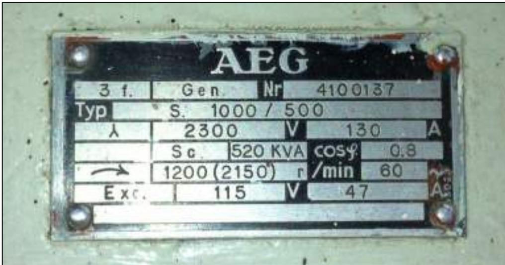
Figura 3.32: Placa de características del Generador síncrono III
