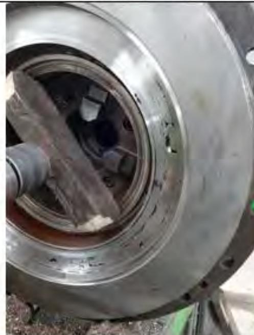
Fabricación, instalación y maquinado de blindajes y laberintos en tapas de turbina
