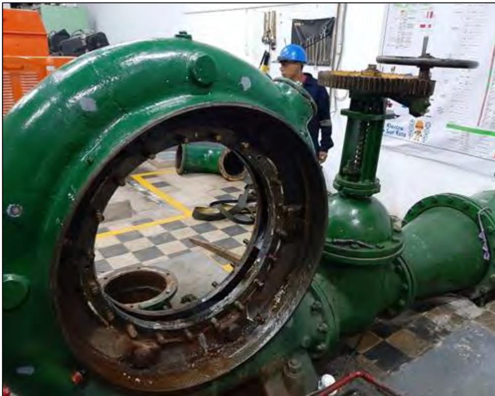
Figura 4.5: La cámara espiral de la turbina Francis de la PCH de Hercca
