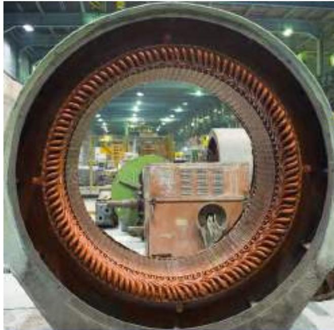
Figura 2.17: Estator y los devanados de armadura del generador síncrono
