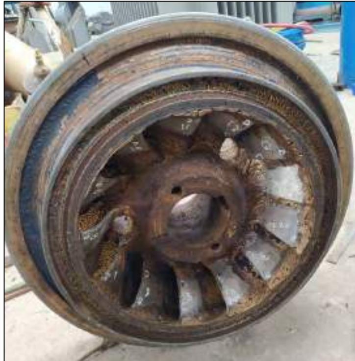
Figura 3.24: El rodete luego del desmontaje para su mantenimiento
