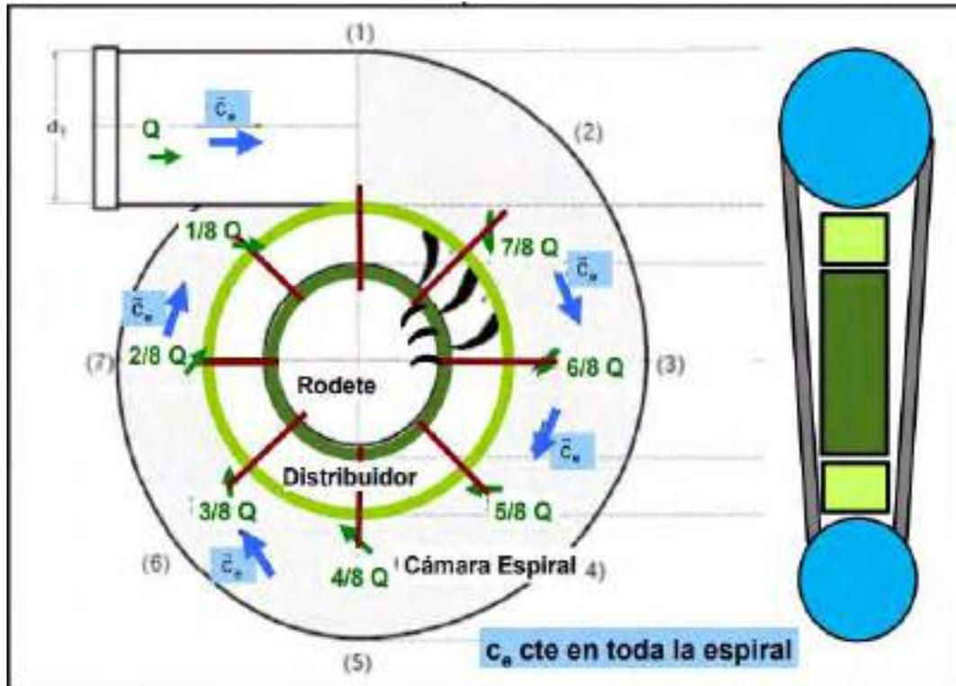
Figura 4.6: Esquema de la cámara espiral de la turbina Francis
