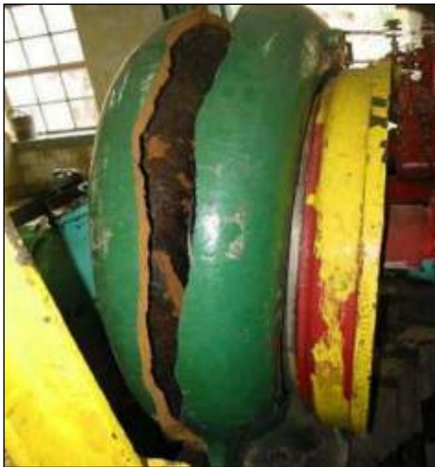
Figura 1.6: Rotura del caracol de la turbina Francis, evento que se dio por fatiga del material
