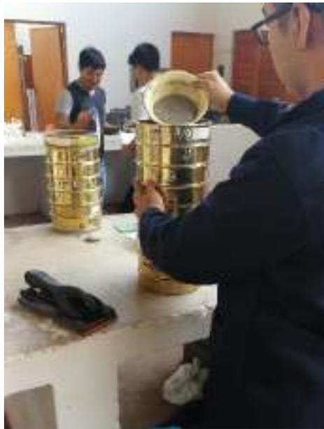
Figura 21. Tamizado de agregado fino
