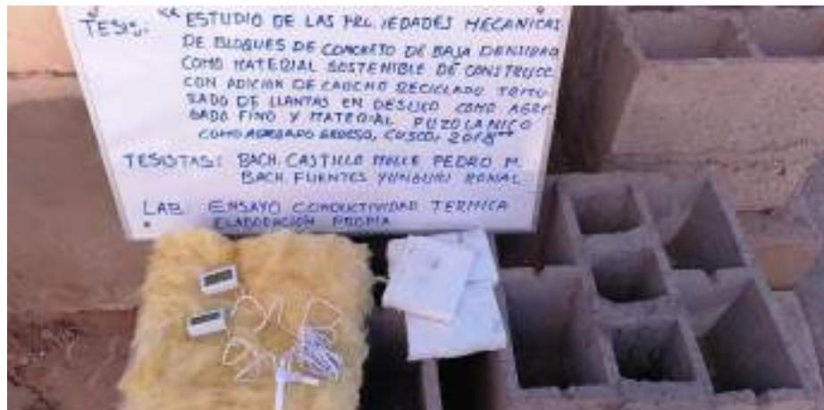
Figura 54: Equipos y materiales utilizados para el ensayo de aislamiento térmico
