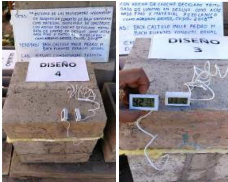
Figura 56: Ensayo de aislamiento térmico - conductividad térmica
