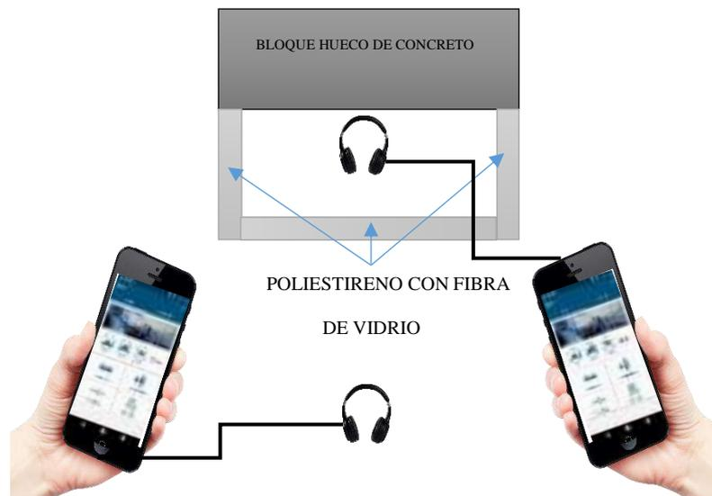
Figura 47: Grafico representativo ensayo de aislamiento acústico
