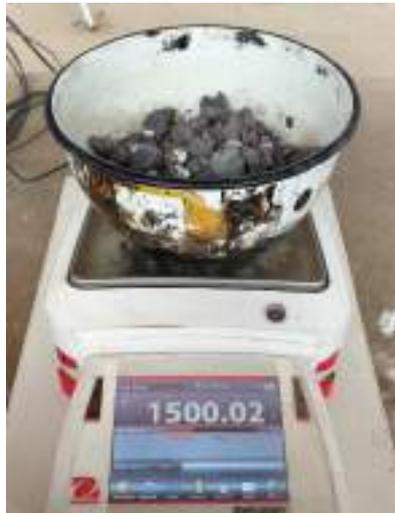
Figura 23. Muestra con 1500 gr de agregado grueso para el ensayo granulométrico
