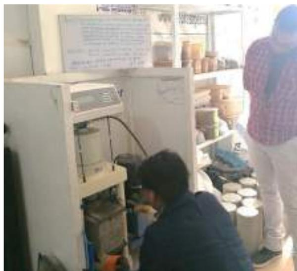
Figura 38 Colocado de los bloques de concreto en la Maquina de ensayo a compresión Axial
