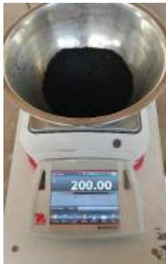
Figura 17. Balanza del laboratorio de la EPIC - UNSAAC con muestra de caucho granulado
