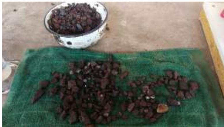
Figura 25. Secado superficial del agregado grueso con un paño
