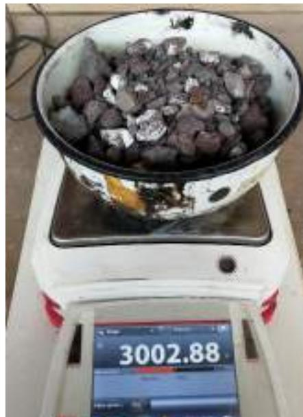
Figura 24. Muestra con 3000 gr aprox. para ensayo de peso unitario
