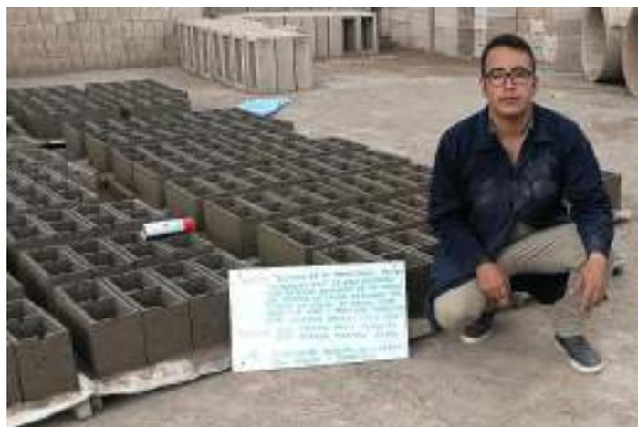
Figura 37 Bloques huecos de concreto
