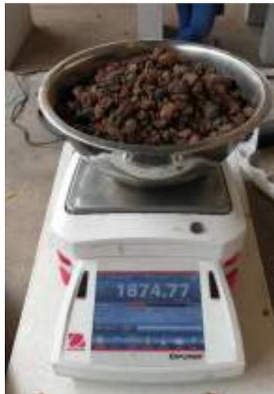
Figura 11. Balanza del Laboratorio De Mecánica De Suelos Y Materiales con muestra de material Puzolánico
