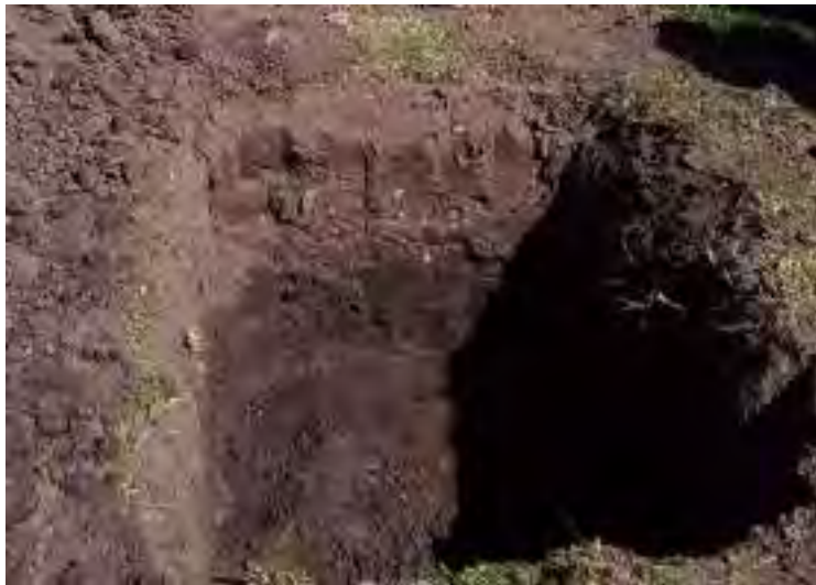
Fotografía N° 21: se observa la calicata con suelo edáfico y materia orgánica color negro. FUENTE: Propia
