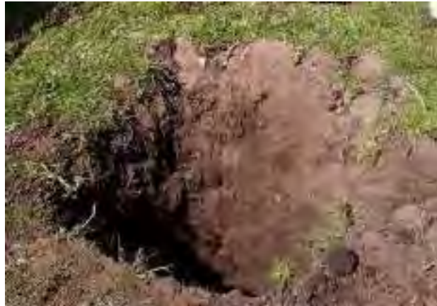
Fotografía N° 19: se observa la calicata con ausencia de nivel freático y presencia de materia orgánica. FUENTE: Propia
