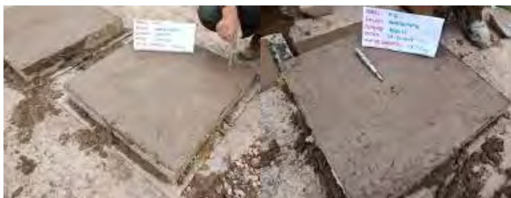
Figura 119. ensayo con penetrómetro pocket en panel cuadrado de shotcrete cada 30 minutos, cemento tipo IP
