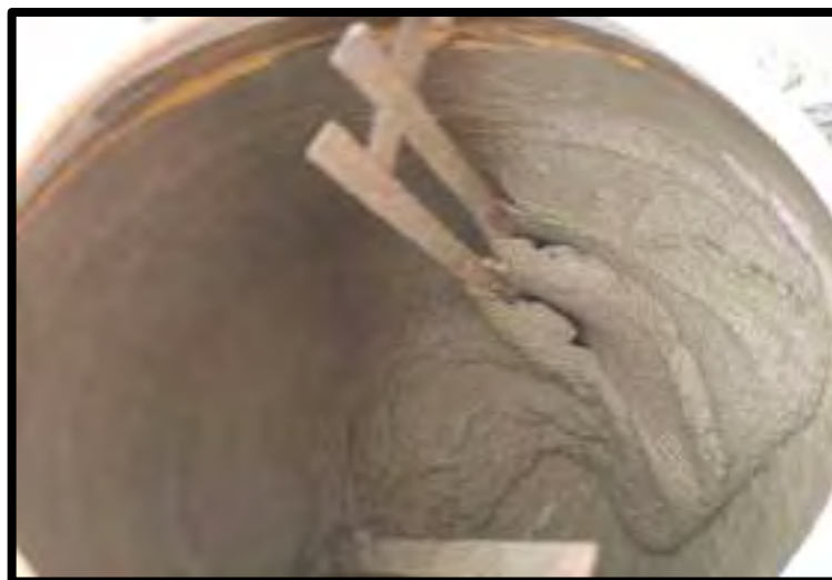
Figura 87. Mezcla de tanda de prueba N°2, reacción química manifestación de burbujeo.
