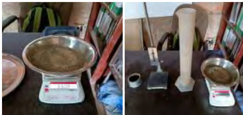
Figura 45. Pesaje de cemento 650 gr. para ensayo
