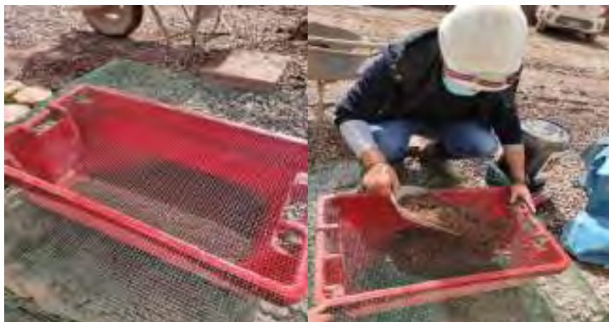
Figura 133. Tamizado de material por malla de \frac{3}{8} "
