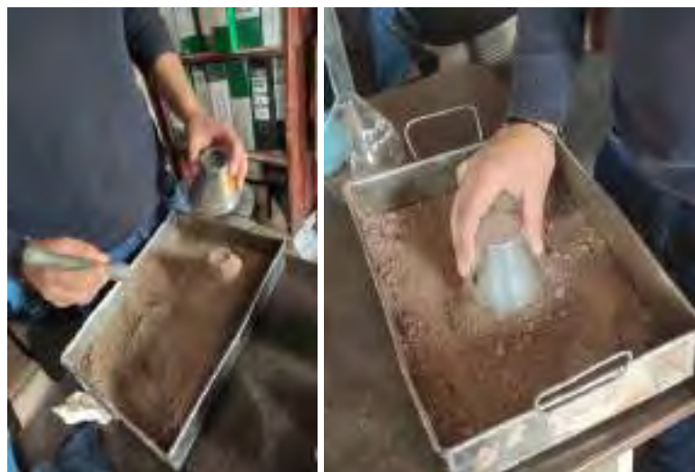
Figura 66. Muestra saturada superficialmente seca (sss).
