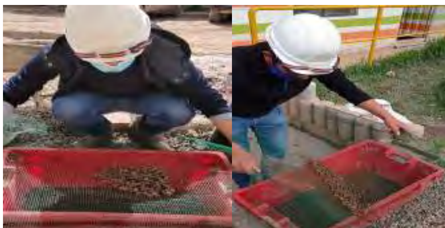
Figura 134. Preparación de muestra tamizada por malla de \frac{3}{8} "
