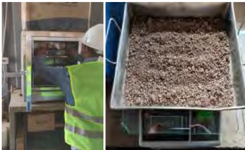
Figura 55. Secado y pesaje final de la muestra para ensayo de lavado por malla N°200
