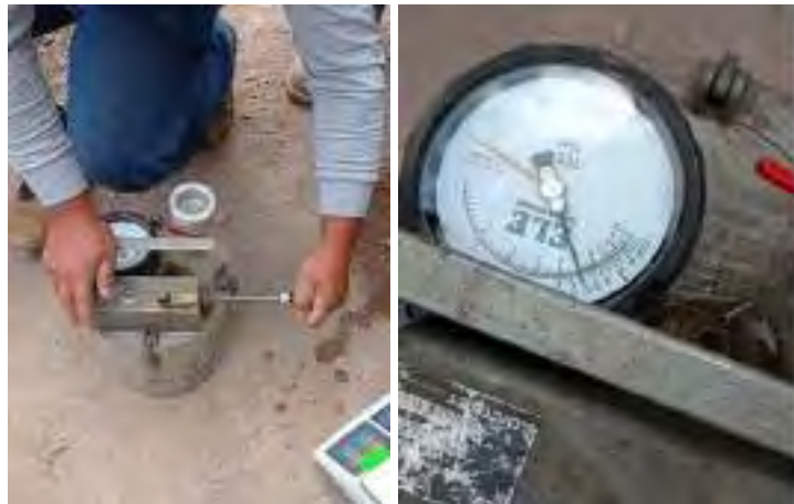
Figura 82. Bombeo de aire en olla Washington.
