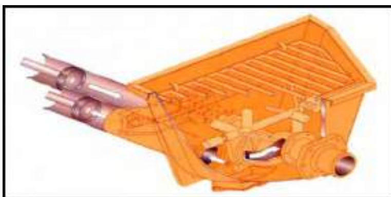
Figura 26. Detalle de tolva y doble cilindro de TK -40.
