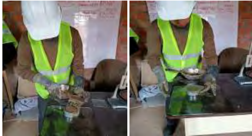
Figura 47. Modelamiento de espécimen en tronco -cónico
