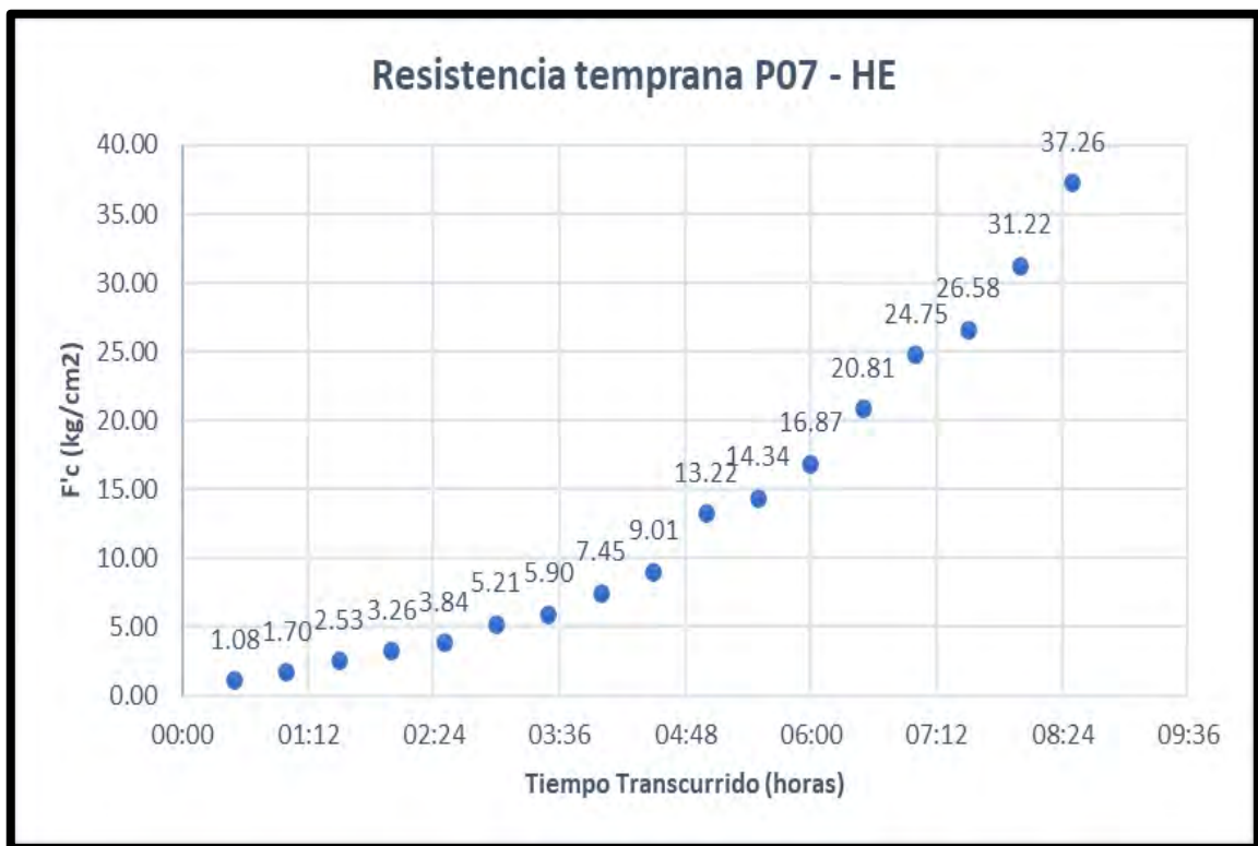
Figura 143. Resistencia Inicial con penetrómetro pocket para P07-HE
