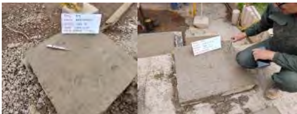
Figura 118. ensayo con penetrómetro pocket en panel cuadrado de shotcrete
