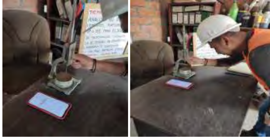
Figura 49. Penetraciones de aguja para lectura
