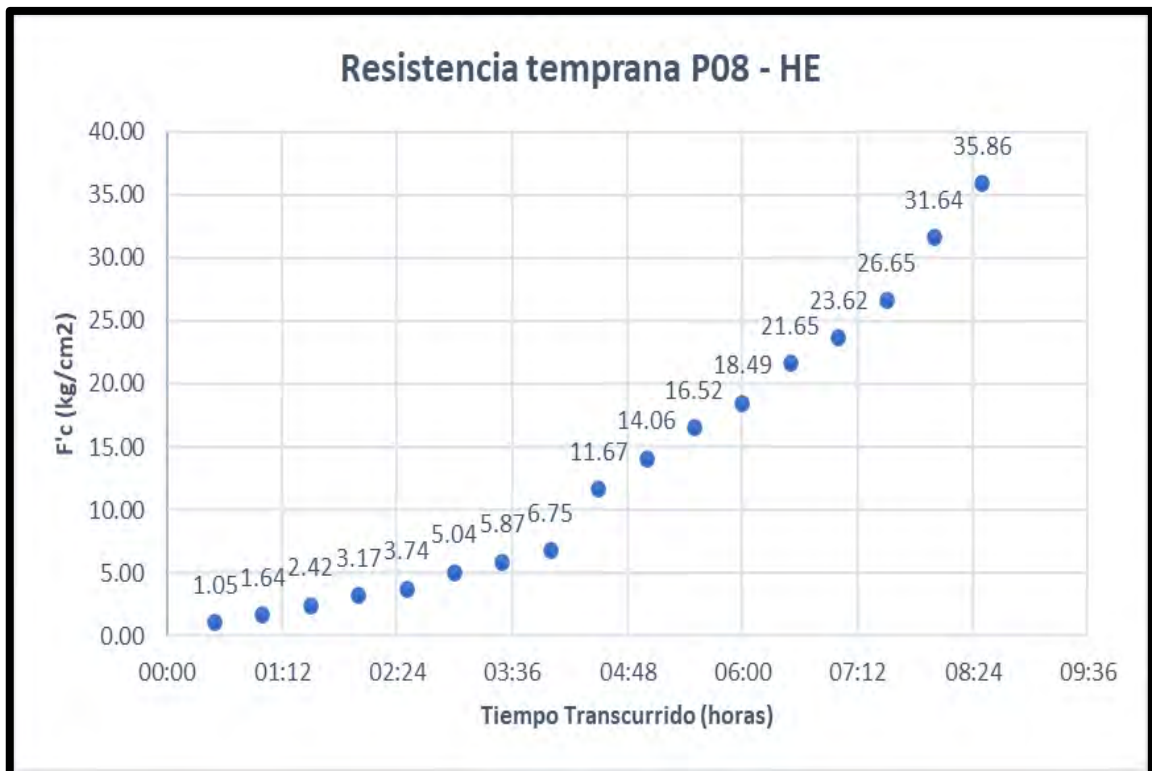
Figura 144. Resistencia Inicial con penetrómetro pocket para P08-HE
