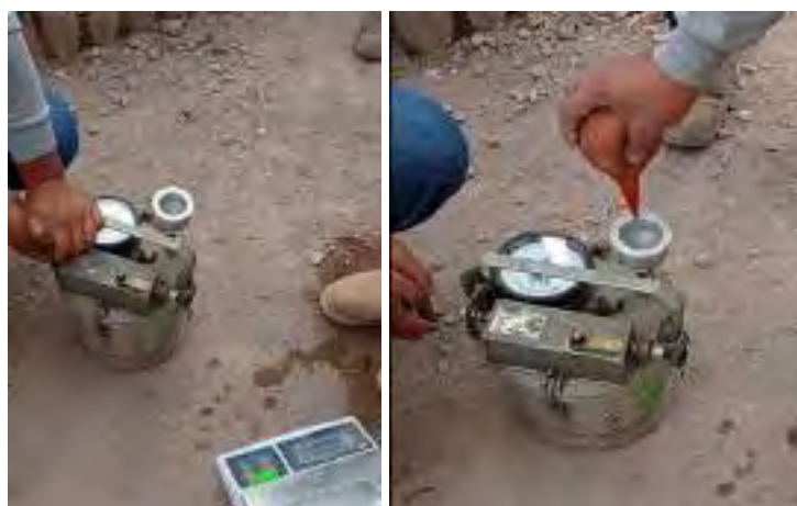
Figura 81. Llenado de válvulas de purga de olla Washington.
