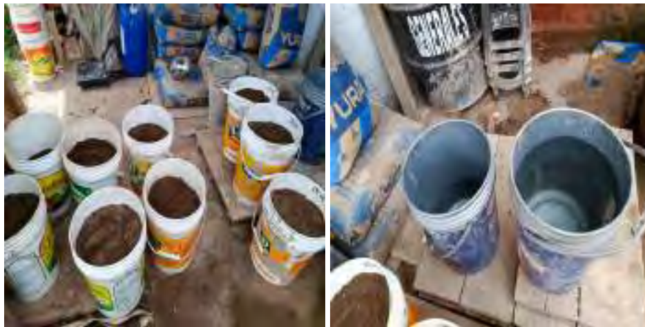
Figura 95. Llenado de baldes con agregado fino y agua.
