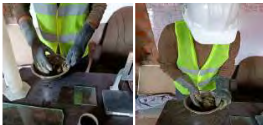
Figura 46. preparación de la pasta de cemento en condiciones normales
