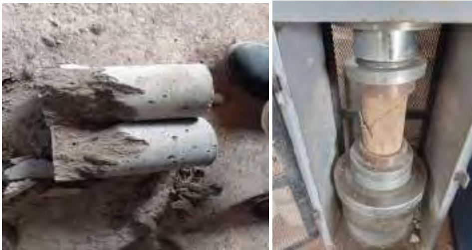
Figura 91. Rotura de probetas de control tanda de prueba N°5
