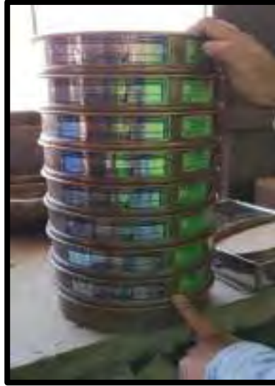
Figura 58. Colocación descendente de tamices y vertido de muestra
