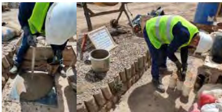
Figura 88. Mezcla de tanda de prueba N°3, revenimiento y elaboración de probetas.
