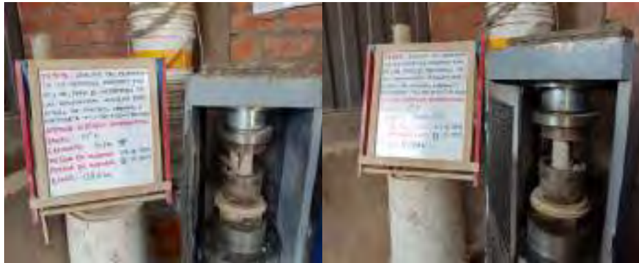
Figura 129. Testigos cilíndricos ensayados IP y HE.
