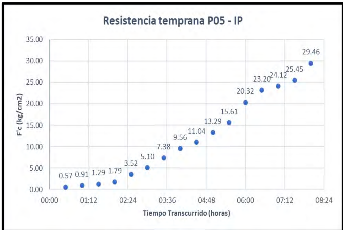
Figura 141. Resistencia Inicial con penetrómetro pocket para P05-IP
