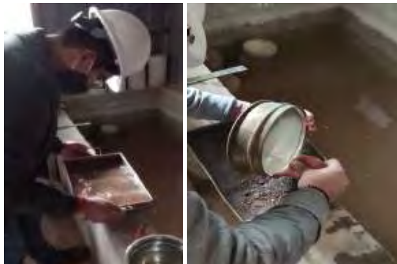
Figura 54. culminación de lavado y retorno de material retenido por la malla N°200
