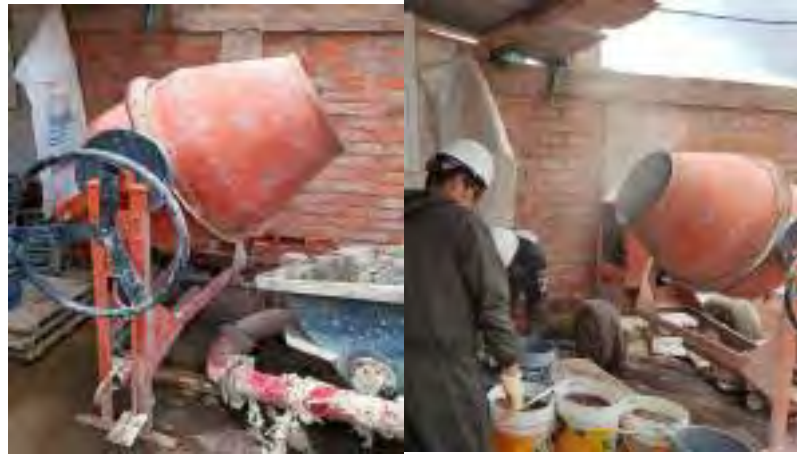
Figura 111. Mezcladora de concreto de 11 pie 3 .
