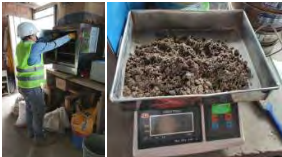
Figura 70. Secado de muestra y pesaje de material seco.
