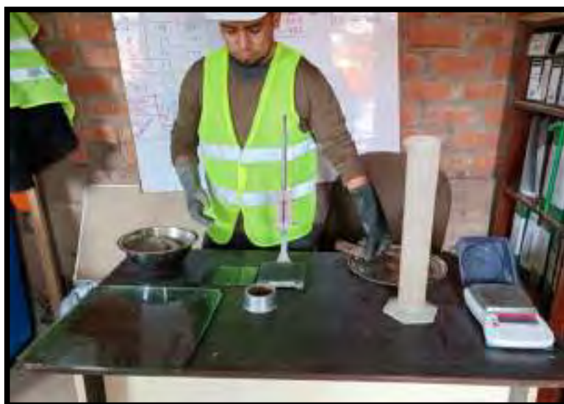
Figura 21. Instrumentos para el ensayo de fraguado de cemento con aguja Vicat
