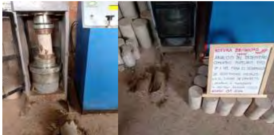
Figura 90. Probetas de control tanda de prueba N°4
