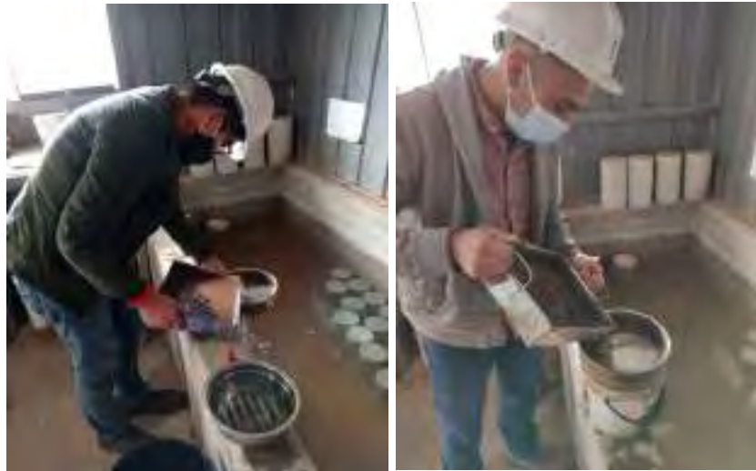
Figura 53. Agitado y decantación de agua sobre malla N°200
