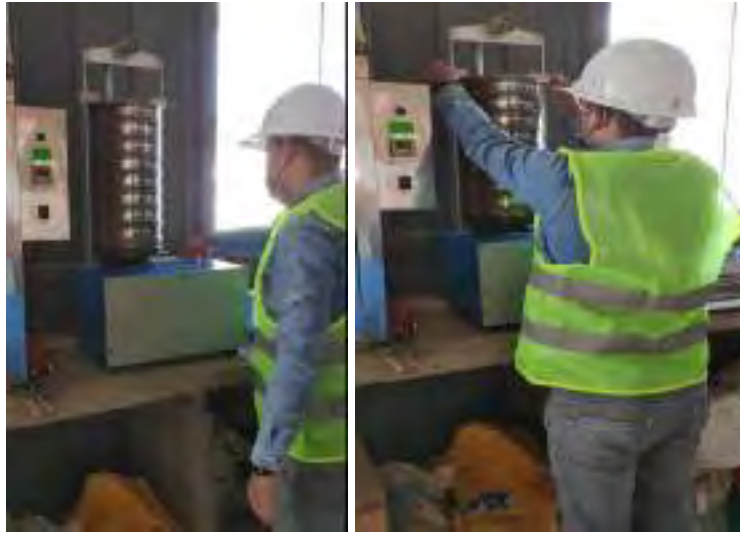
Figura 60. Agitador mecánico para tamizar muestra
