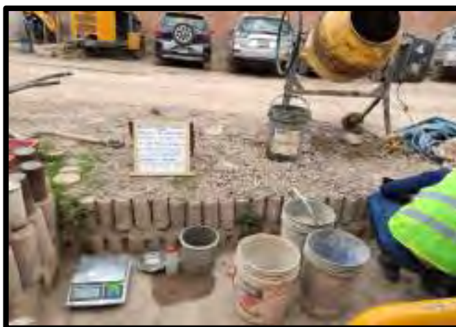
Figura 85. Desarrollo de tandas de Prueba en laboratorio para diseño de shotcrete.
