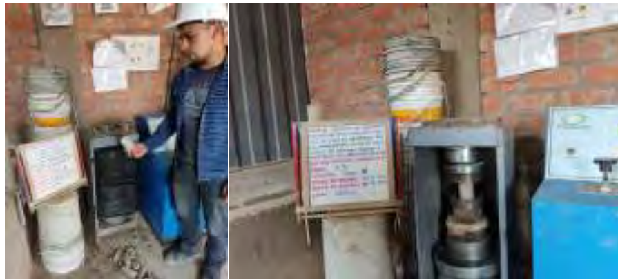
Figura 127. testigos cilíndricos y colocación en la máquina de compresión digital.
