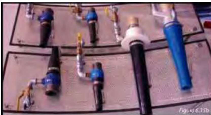
Figura 30. Tipos de boquillas para aplicación concreto lanzado
