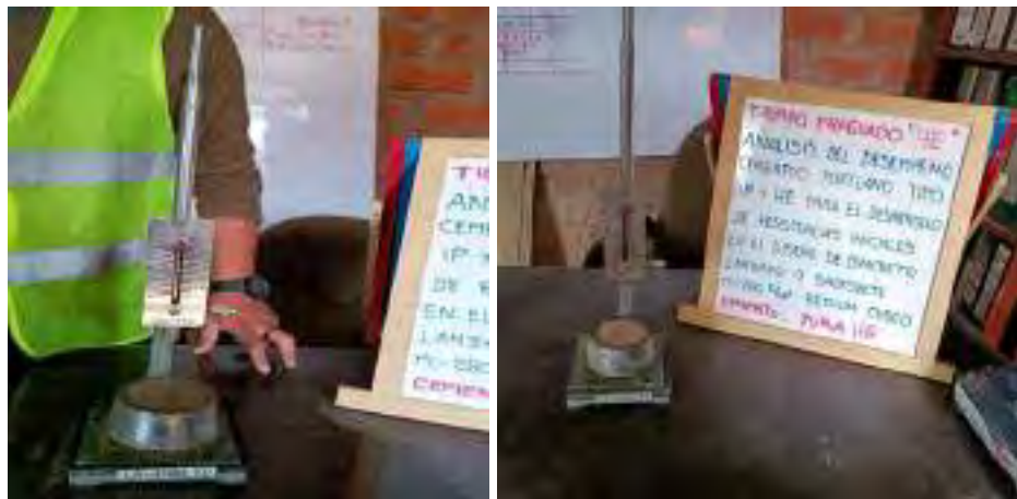
Figura 50. Tiempo de fragua fina de cemento Yura IP
