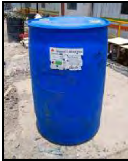
Figura 19. Aditivo Acelerante de fragua Sigunit L60 AF Plus
