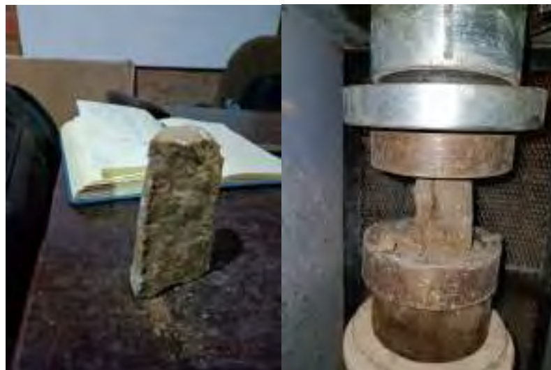
Figura 130. Detalle de rotura de briquetas.
