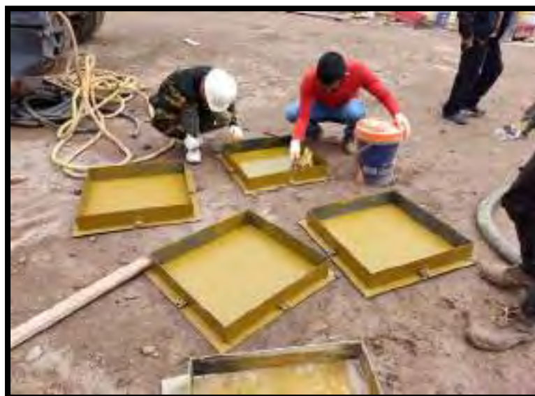
Figura 37. Engrasado de moldes para recibir mezcla
