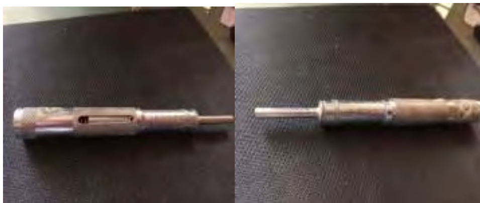
Figura 117. Penetrómetro de bolsillo para Concreto— H-4134
