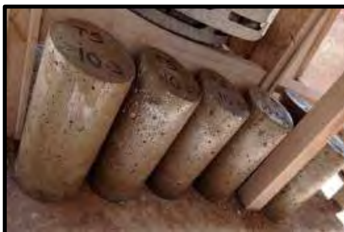
Figura 89. Mezcla de tanda de prueba N°3, probetas sin alcanzar la fragua final a 24 hrs.
