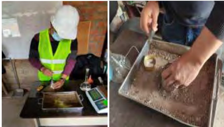
Figura 65. Uso de molde cónico y apisonado.
