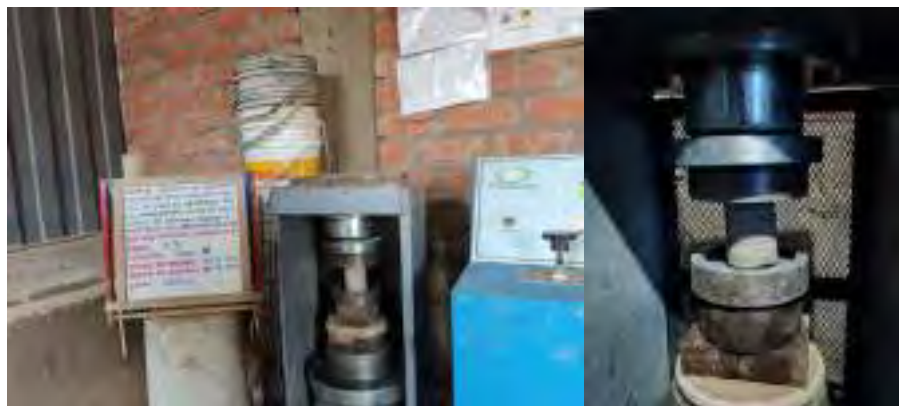
Figura 128. Aplicación de la carga de compresión.
