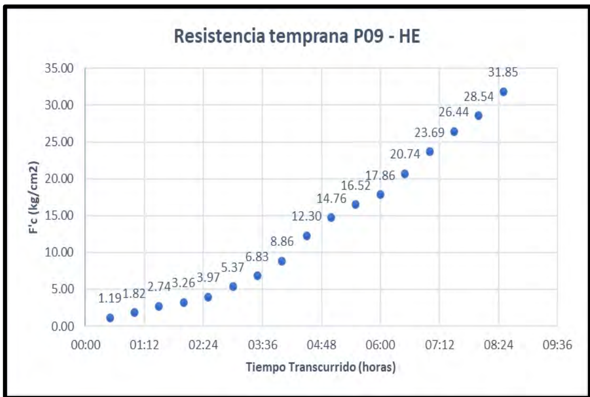
Figura 145. Resistencia Inicial con penetrómetro pocket para P09-HE
