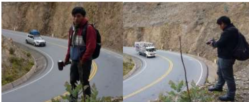
TOMA DE DATOS DE VELOCIDADES EN TRAMOS CURVOS DE LA RED VIAL PE - 30C KM CON RADAR DE VELOCIDAD.
