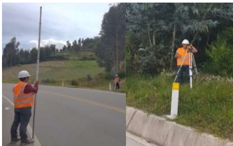
TOMA DE DATOS DE LAS COTAS EN LA RED VIAL PE - 30C CON NIVEL DE INGENIERO
