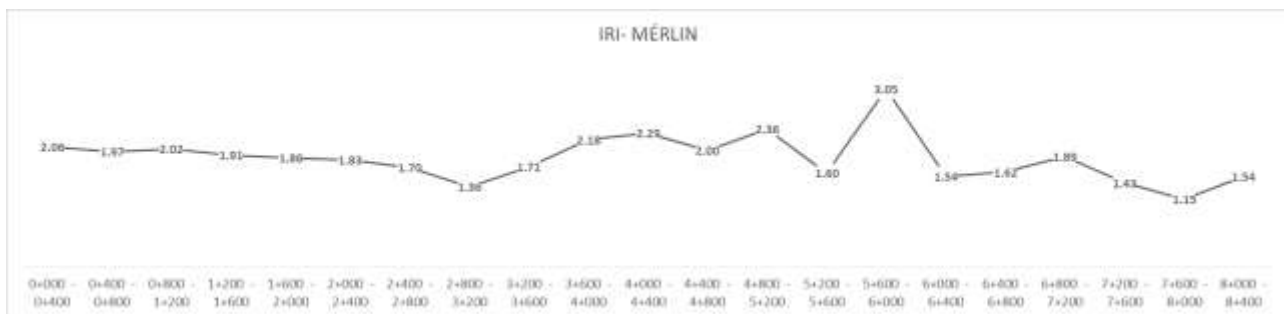
Fig. 24. Resumen de valores de IRI medidos con Merlín en 8.4 km de vía.
