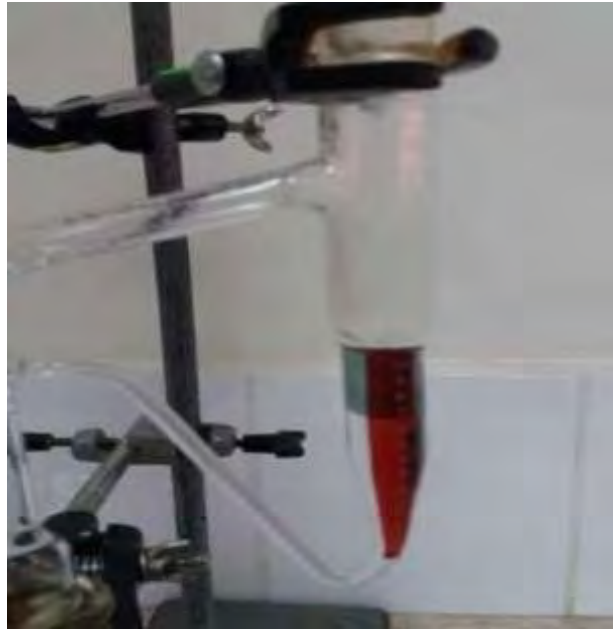
Figura 41: Extrayendo aceite esencial de la especie biológica Minthostachys spicata (Benth) Epling
