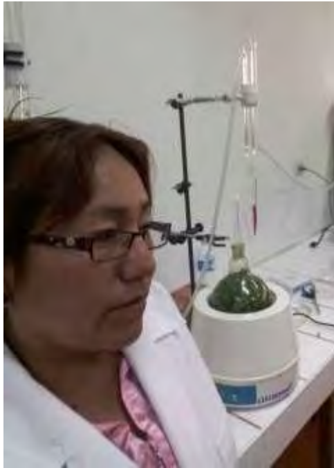
Figura 39. Extrayendo aceite esencial de la especie biológica Mentha x piperita var. citrata (Ehrh.) Briq
