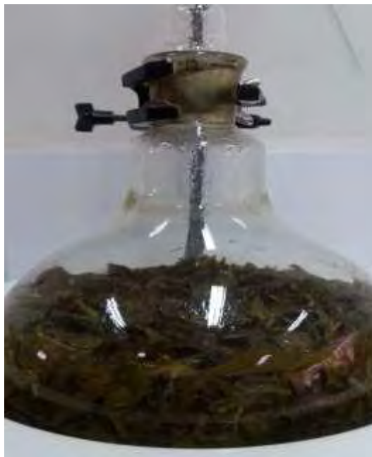
Figura 40: Extrayendo aceite esencial de la especie biológica Tanacetum Vulgare
