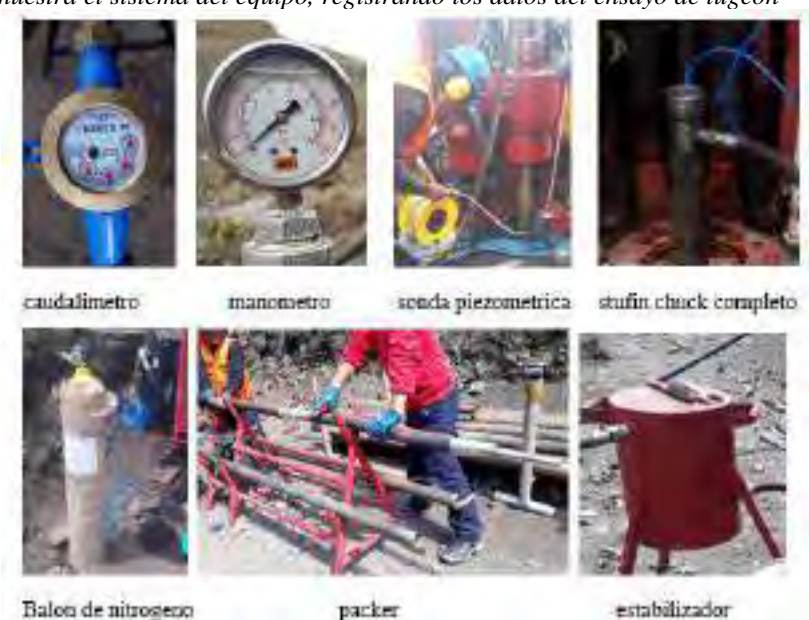
Foto N° 8.53: donde muestra el sistema de equipo para la realización de las pruebas de permeabilidad
