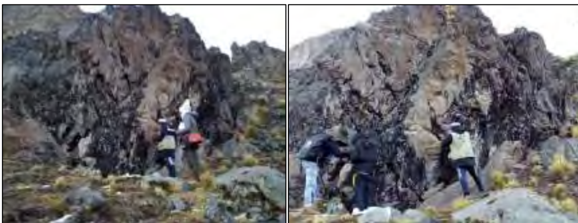
Foto N° 4.9 y 4.10. Medida de azimut, Buzamientos y dirección de buzamiento en el macizo rocoso de composición andesita a riolita en la parte alta de la margen derecha del rio Husillo a la altura del dique de la presa.
