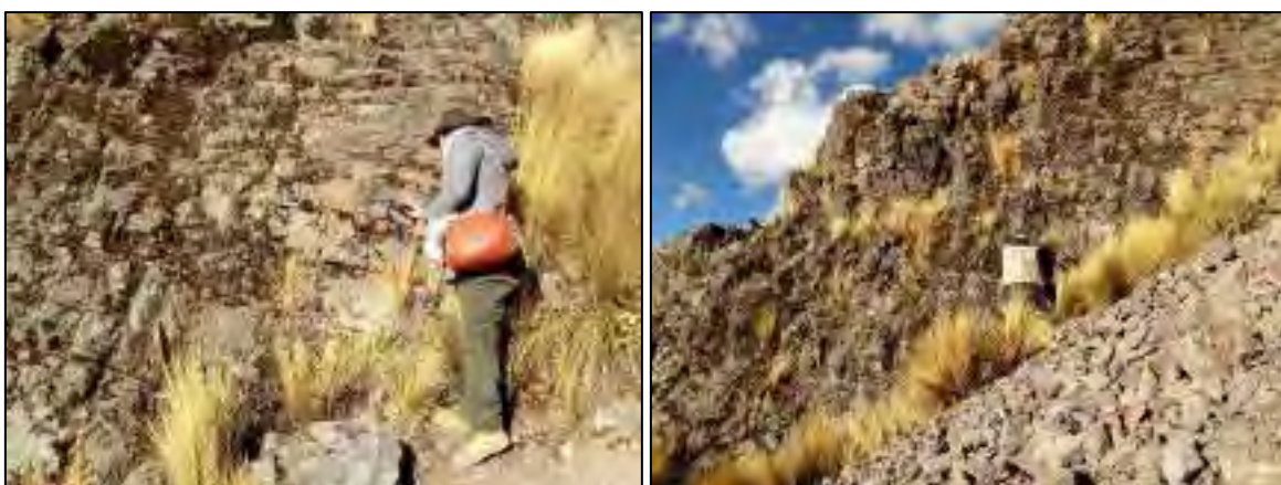
Foto N° 4.7 y 4.8. Medida de azimut, Buzamientos, dirección de buzamiento, abertura en el macizo rocoso de composición andesita a riolita en la parte alta de la margen derecha del río Husillo a la altura del dique de la presa.
