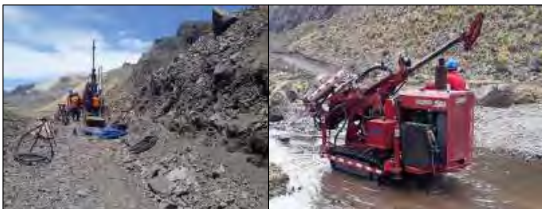
Foto N°5.2 y 5.3: Pruebas de infiltración profundas, método de Lugeón en eje de la presa
