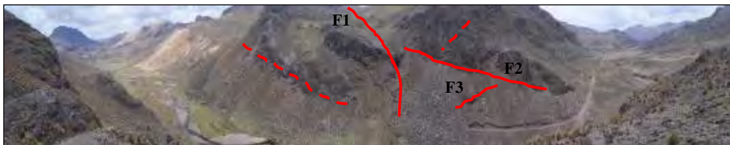
Foto N°4.11 y 4.12. Vista panorámica de la margen izquierda de río Huisillo mostrando los rasgos superficiales de las falla, F1, F2, F3 y también se puede ver las fallas inferidas.
