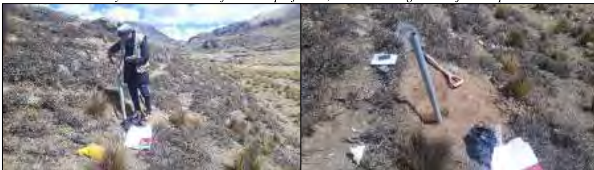
Foto N°5.2 y 5.3: Pruebas de infiltración profundas, método de Lugeón en eje de la presa
