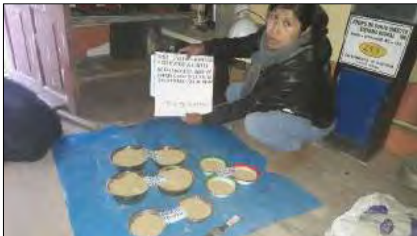
Foto N° 8.12: Cuarteo de muestra para el ensayo de corte directo.
