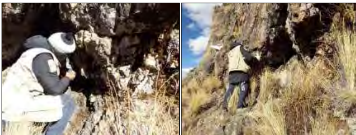
Foto N° 4.5 y 4.6. Medida de azimut, Buzamientos, dirección de buzamiento y abertura de las fracturas en el macizo rocoso de composición andesita a riolita en la parte alta de la margen derecha del río Husillo a la altura del dique de la presa.
