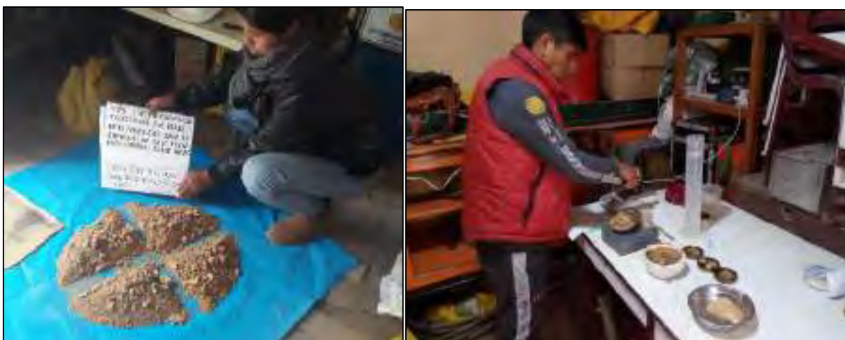
Foto N° 8.1. Foto Izq., Cuarteo de muestra para diferentes ensayos correspondientes al vaso de la presa. Foto Der., ejecución del ensayo de límites de consistencia.
