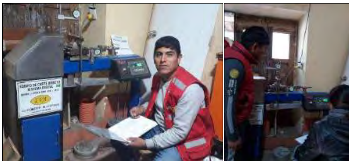
Foto N° 8.13: En el cual se observa la realización del ensayo de corte Directo, de la zona inestable del vaso.
