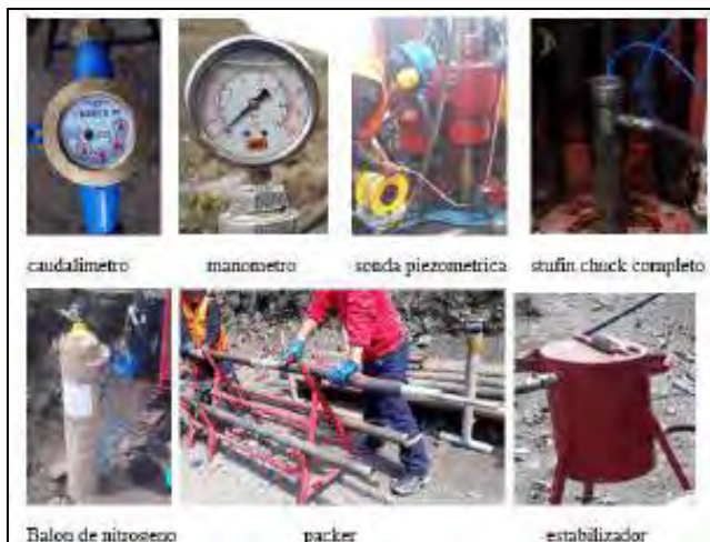
Foto N° 5.7: donde muestra el sistema del equipo, registrando los datos del ensayo de lugeon
