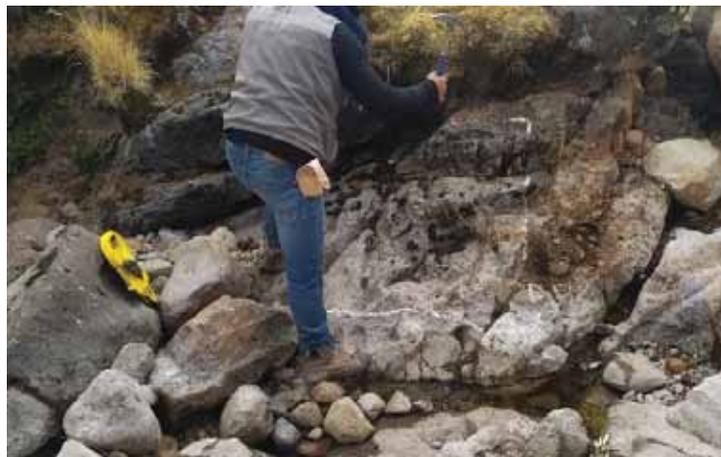
**Nota:** Muestreo de rocas, para el ensayo de carga puntual y descripción petrográfica con muestra de mano.
