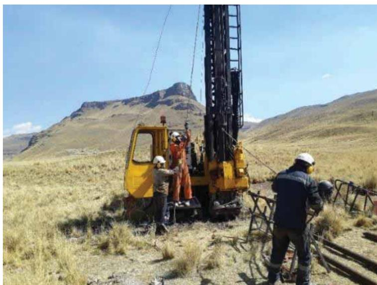
**Nota:** Se muestra una máquina para perforaciones diamantinas. (Elaboración propia)
