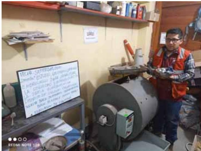
**Nota:** Colocación de la muestra de roca de 10 kg en la cámara de Abrasión de los ángeles con 12 billas normalizadas durante 1000 ciclos. (Elaboración propia).
