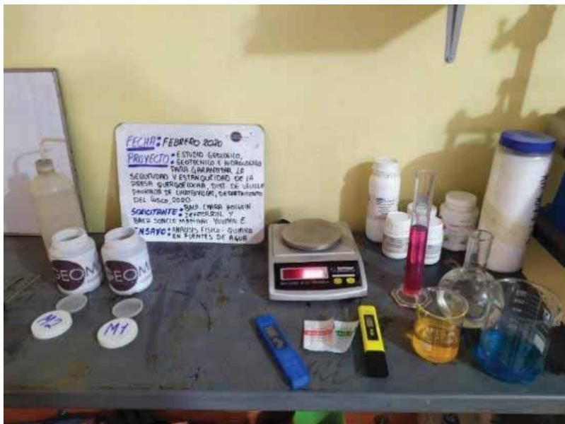
**Nota: Realización de los ensayos de fuentes de agua para la elaboración de concreto.
