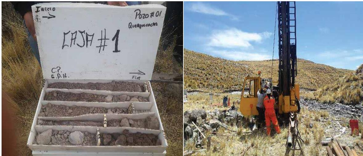
**Nota:** Se muestra a la izquierda caja de extracción de testigos de diamantina y derecho instalación del equipo de perforación diamantina en P – 01.
