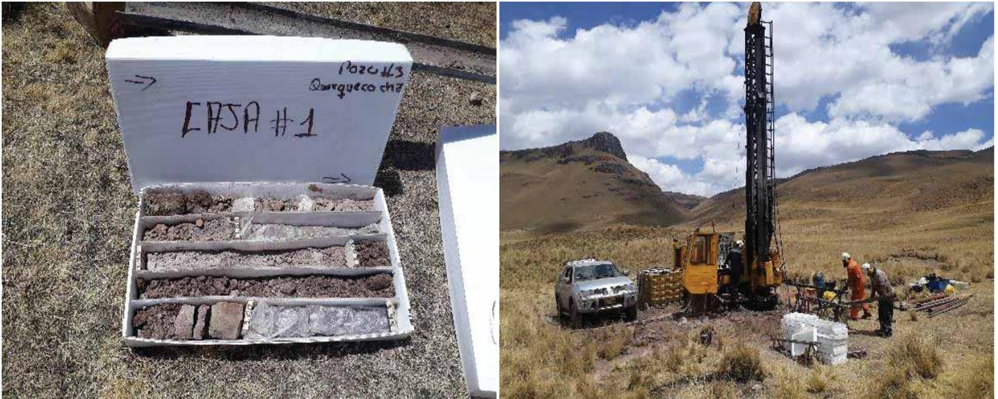
**Nota:** Se muestra a la izquierda caja de extracción de testigos de diamantina y derecho instalación del equipo de perforación diamantina en P – 03.
