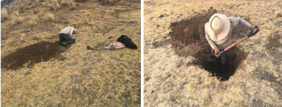
**Nota:** Se observa la excavación de calicatas de manera manual. (Elaboración propia)
