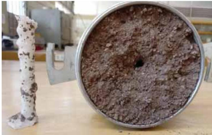
Después de secar la parafina, la muestra se extrajo del molde de compactación y el suelo alrededor del molde de parafina.
