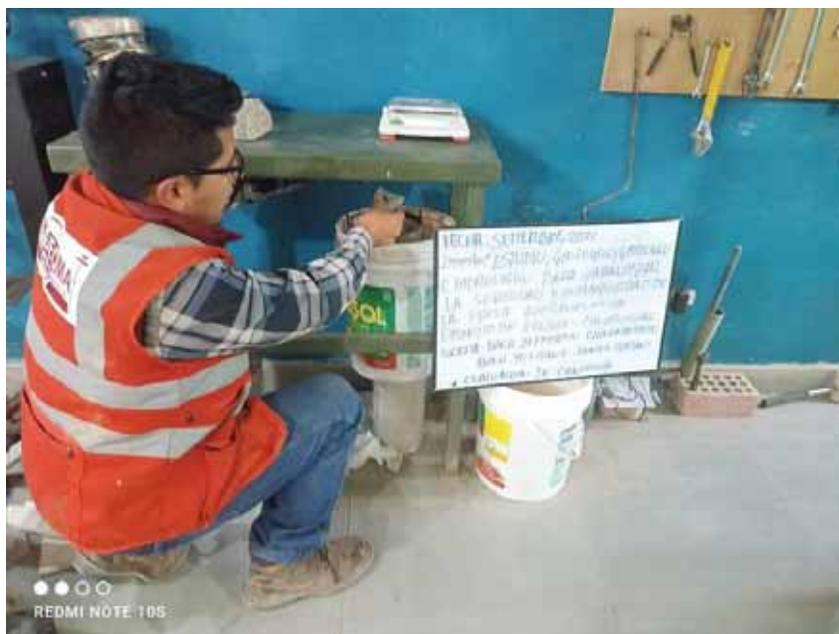
**Nota:** Saturación de la muestra para la determinación del peso específico y absorción. (Elaboración propia).
