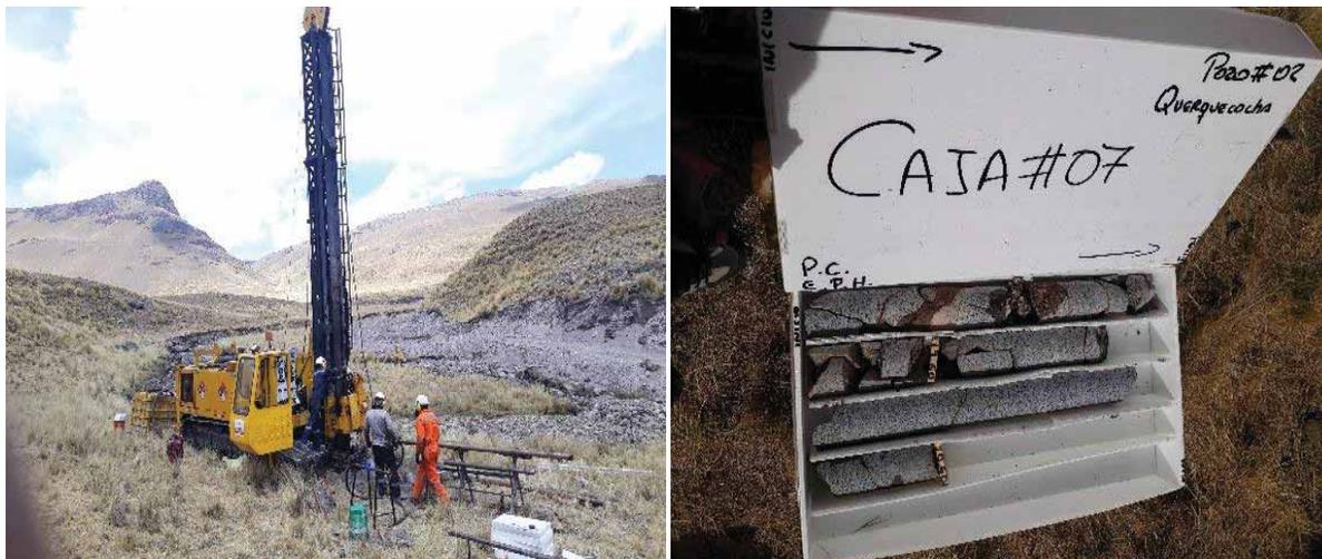
**Nota:** Se muestra a la izquierda caja de extracción de testigos de diamantina y derecho instalación del equipo de perforación diamantina en P – 02.
