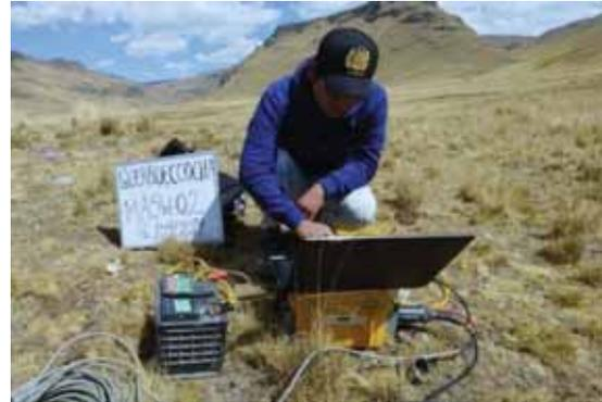
**Nota:** Ejecución del ensayo de MASW en el eje de presa.
