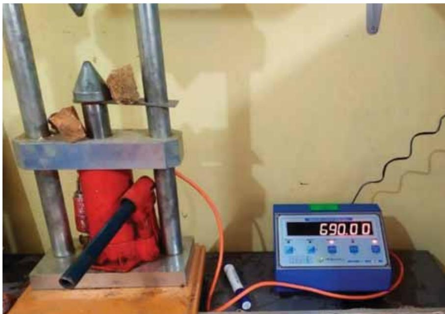
Nota: Se muestran la ejecucion de ensayo de carga puntual (elaboracion propia)
