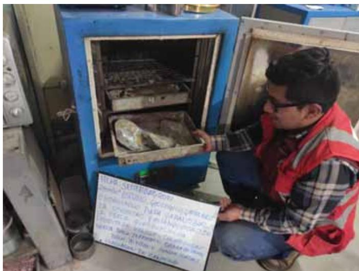
**Nota:** Colocación de las muestras al horno durante 24 horas para determinar el contenido de humedad. (Elaboración propia).
