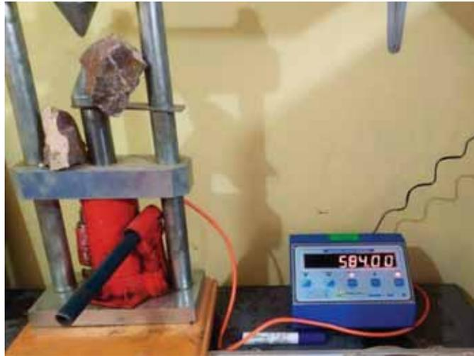
**Nota: Se muestran la ejecucion de ensayo de carga puntual (elaboracion propia)**
