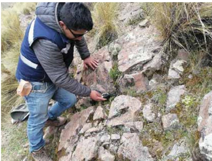
**Nota: Se realiza la medición de una falla, obteniendo valores de Azimut y buzamiento para la falla geológica. (Elaboración propia)**
