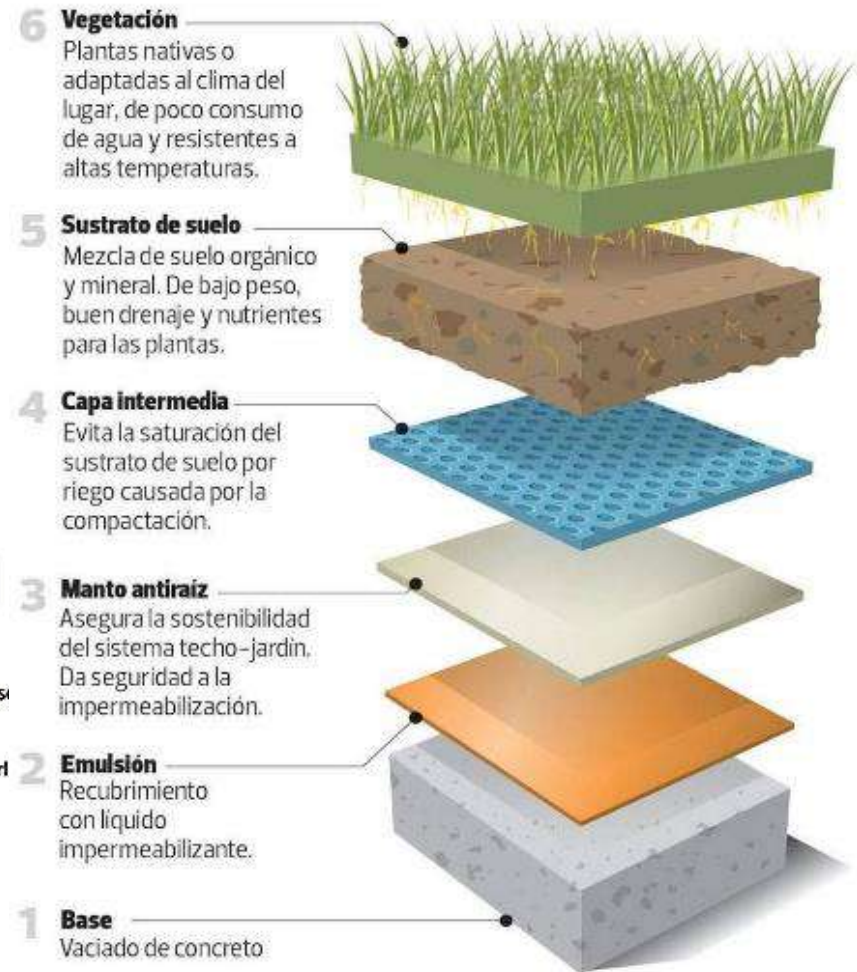
Figura 173. Esquema de techo Verde.
