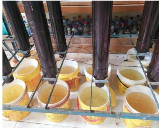
Descarga de columnas lixiviadas.
