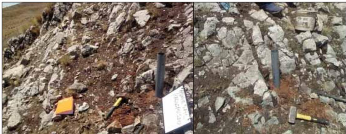
Foto 38: Prueba de infiltración en roca caliza de la formación Arcurquina
