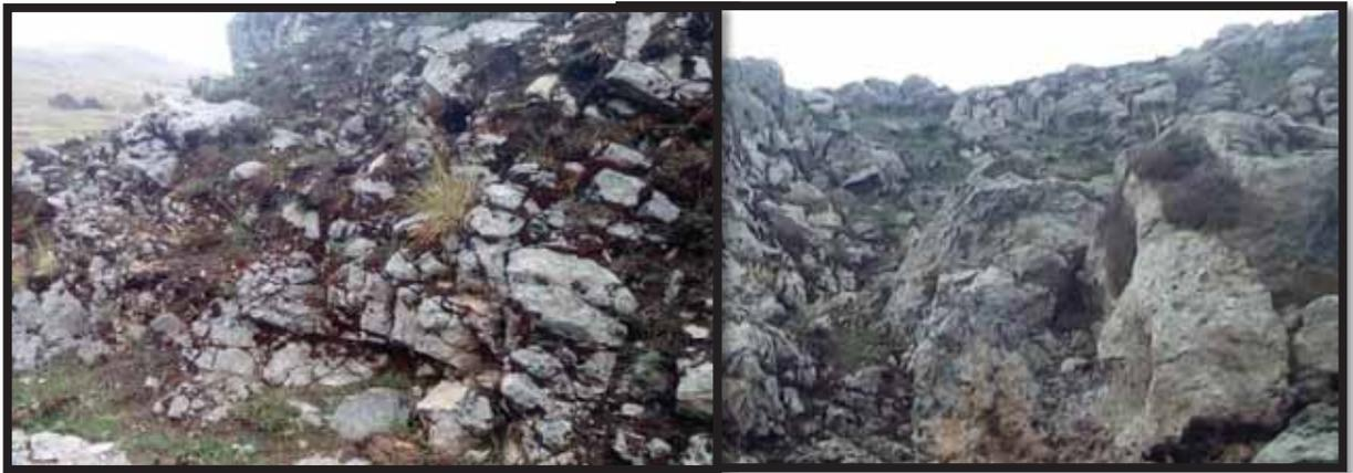
En la siguiente fotografía se observa la presencia de fracturas en roca diorita
