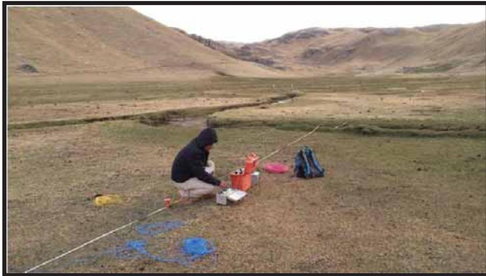
Foto 46: Extendido de cables para ensayo de prospección geofísica método refracción sísmica.
