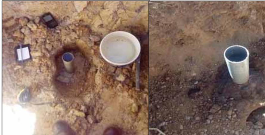
Foto 34: Prueba de infiltración en trinchera suelo flúvio glacial
