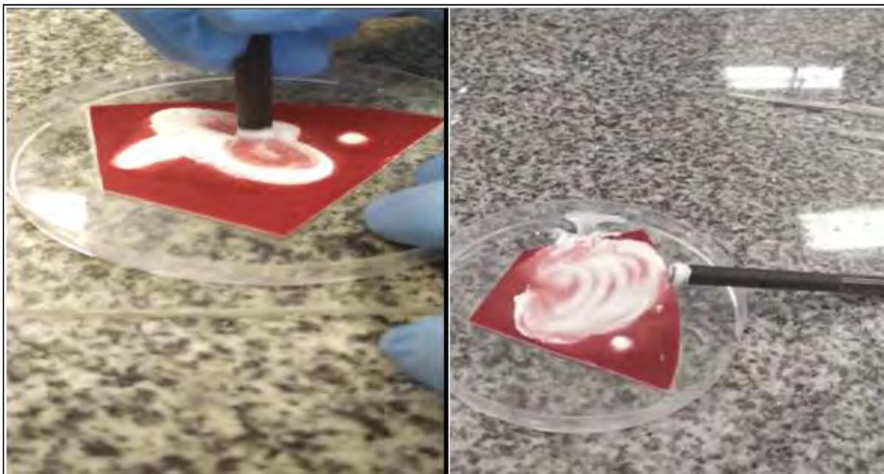
Figura 31: Imágenes del pulido de carbón vítreo en forma de ocho sobre la alúmina (fuente: elaboración propia)
