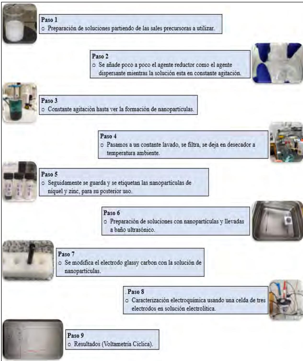
Esquema 1: Diagrama de flujo a seguir para la síntesis de NPsNi y NPsZn, la modificación del electrodo de trabajo y la caracterización de NPs
