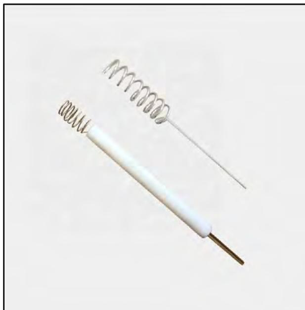
Figura 17: Electrodo auxiliar de alambre de platino (Fuente: (XRFSCIENTIFIC, ss.ff)).
