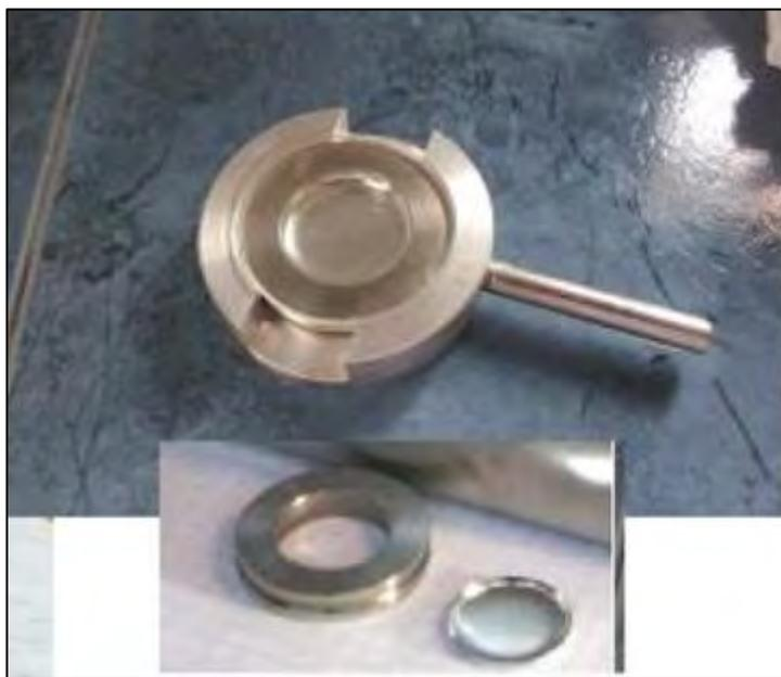
Figura 30: Anillo metálico, placa circulas y porta muestras del equipo de difracción de rayos X
