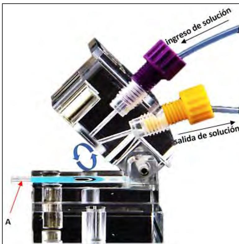
Figura 36: Armado de celda electroquímica de chorro de pared para un sistema de flujo. A) Electrodo serigrafiado de carbono fuente: (Laboratorio del grupo de investigación en electroquímica y materiales (GIE&M), Facultad de Ciencias – Escuela Profesional de Química, Universidad Nacional de San Antonio Abad del Cusco).
