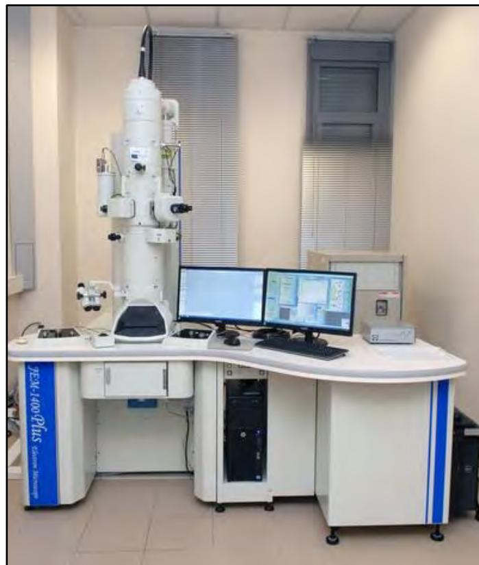
Figura 9: Equipo de microscopio electrónico de transmisión (Fuente: (SSTTI-UA, 2011)).
