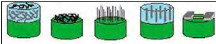
Figura 18: Superficies de electrodos de carbón vitreo modificados (Fuente: (Garay & Camargo, 2018)).
