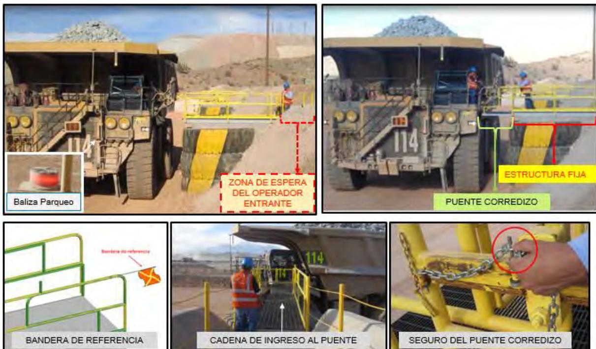
Figura N°04: Partes del puente corredizo
