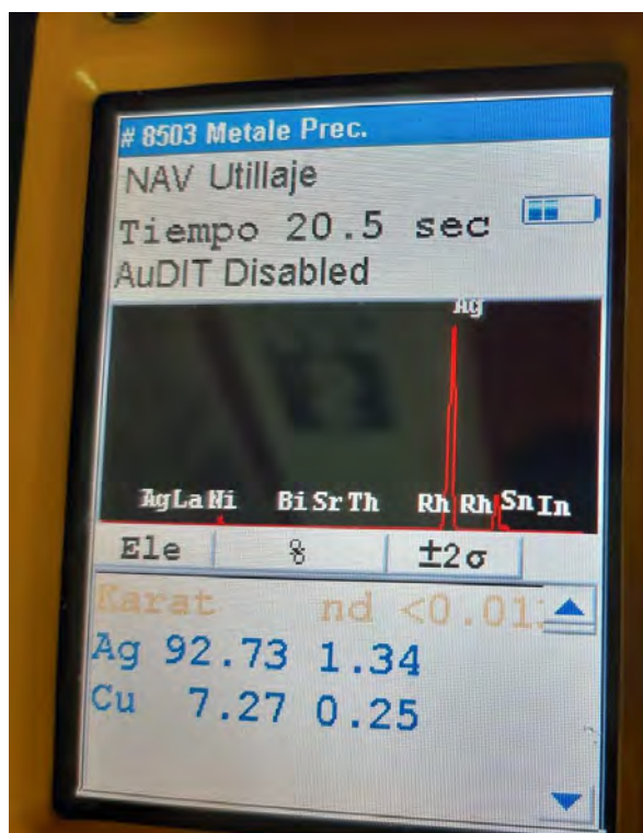
Figura B-6 resultado del análisis de rayos X, de las probetas post sinterización.
