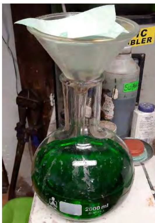
Figura B-9 proceso de filtrado de la solución de nitrato de cobre \text{Cu}(\text{NO}_3) . Adaptado de Empresa Oro Inca
