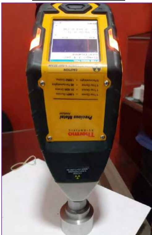
Figura B-1 equipo de rayos X, que mide el % de metal presente en las muestras.
