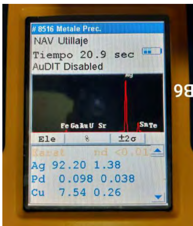
Figura B-7 resultado del análisis de rayos X, de las probetas post sinterización.
