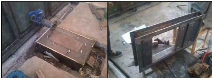
Figura 7.4: Bloque de cimentación y marco base de bomba centrífuga
