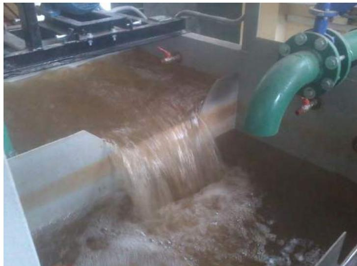
Figura 4.8 Funcionamiento de vertedero trapezoidal
