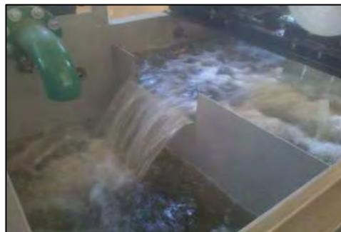
Figura 4.6: Funcionamiento de vertedero rectangular
