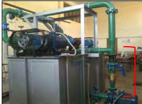
Figura 4.20: Diferencia de altura entre bomba centrífuga y turbinas
