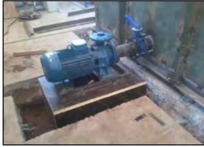
Figura 5.22: Cimentación tipo bloque para bomba centrífuga mono bloque
