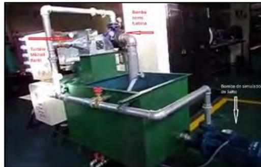
*Figura 1.5: Módulo para BFT y turbina convencional. UCSM, Arequipa*
