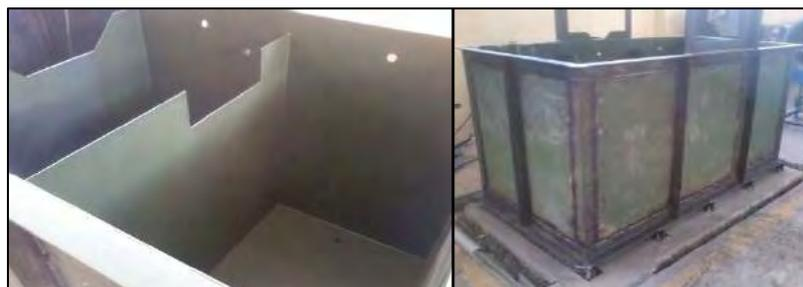
Figura 7.1: Planchas y angulares de reservorio
