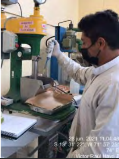
Flotación de minerales por espuma.
