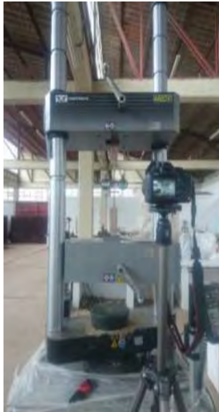
Figura 21. Maquina universal de ensayos del laboratorio de mecánica de suelos y materiales, Facultad de Ingeniería Civil, UNSAAC.
