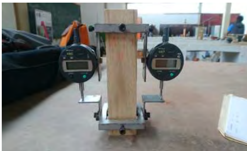
Figura 22. Testigo de compresión paralela listo para ensayar.
