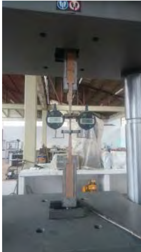
Fotografía 9 - Testigo de tracción paralela colocada en la maquina universal, listo para el ensayo.
