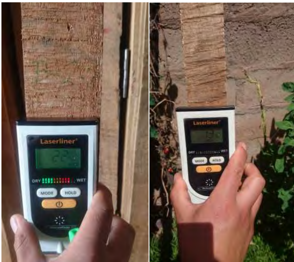
Fotografía 4 – Control de Contenido de Humedad durante el secado, con higrómetro digital.
