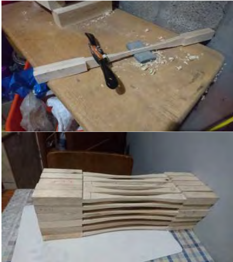
Fotografía 7 – Tallado de Testigo Para ensayo a Tracción.
