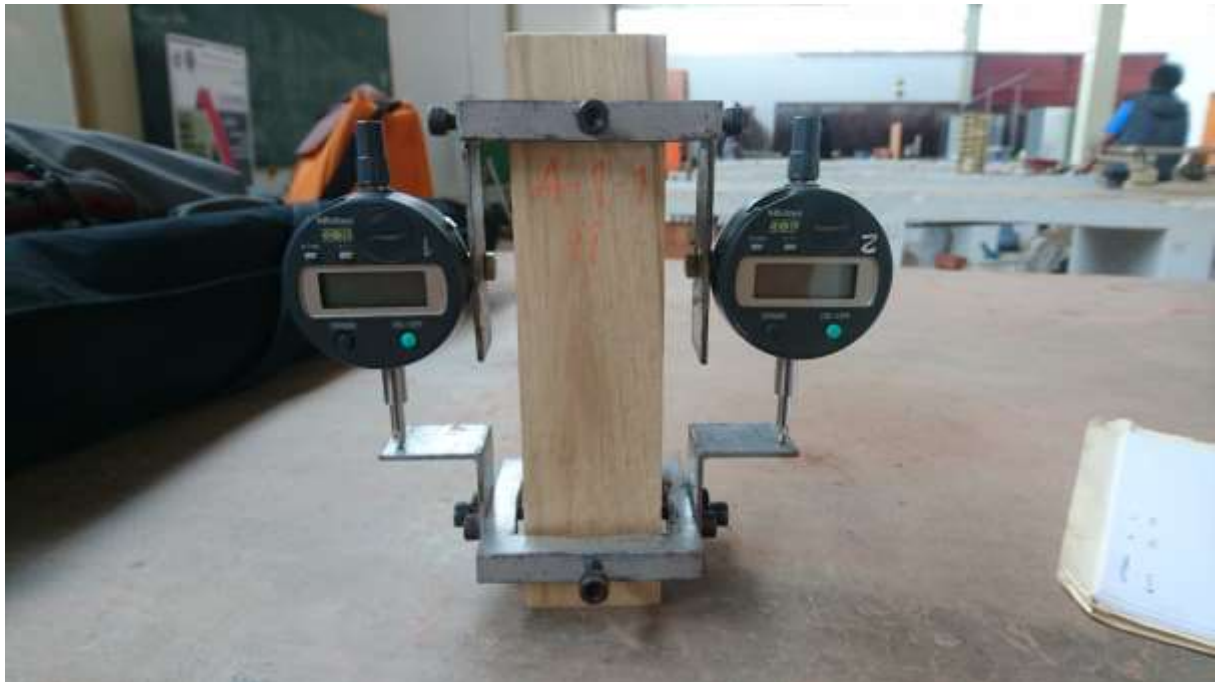
Fotografía 8 – Testigo con acoples y deformímetros dispuestos para ensayo de compresión paralela.
