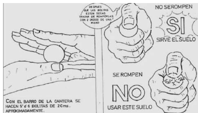
Figura 2.23. Prueba común para uso de material en la elaboración de adobe. Fuente: Delgado, 2006.
