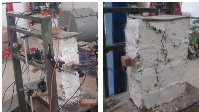
Figura 3.28 Ensayo de compresión simple y la posterior falla de la pila N° 03. Fuente: Elaboración propia, 2019.
