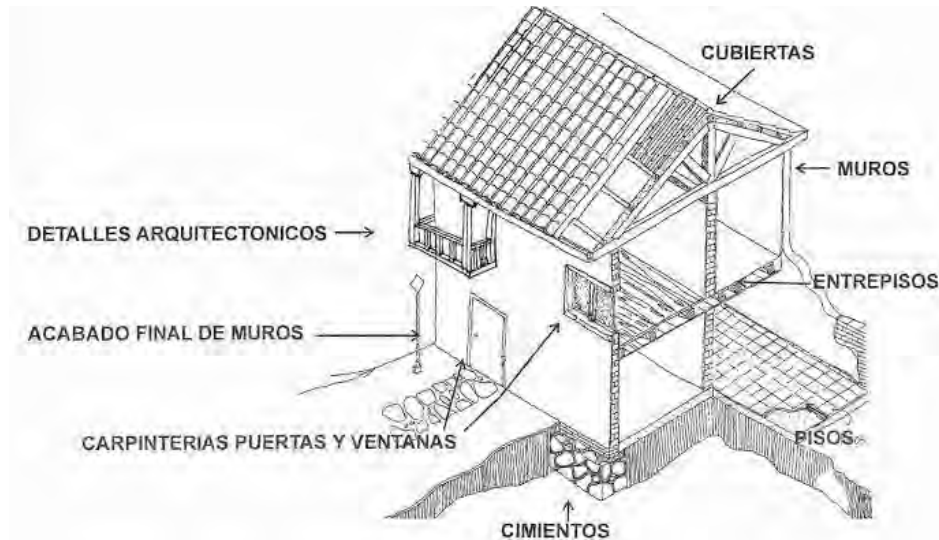
Figura 2.22. Características de las edificaciones de adobe. Fuente Internet, 2019.
