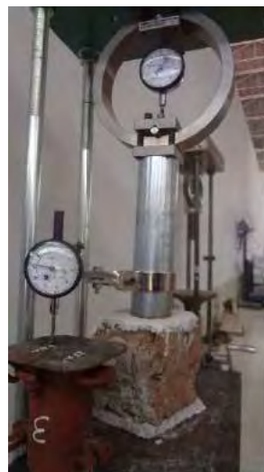
Figura 3.20. Esquema de ensayo de compresión simple, en la Prensa pequeña. Fuente: Elaboración propia, 2019.
