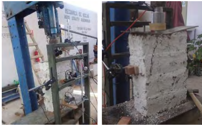
Figura 3.27 Ensayo de compresión simple y la posterior falla de la pila N° 02. Fuente: Elaboración propia, 2019.
