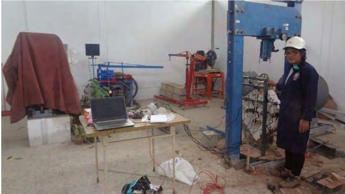
Ensayo de compresión diagonal en la máquina de deflexión. Fotografía: I.A.Q. (2019)
