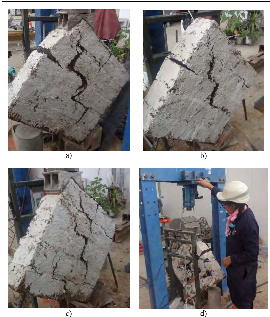
Figura 3.32 Falla de los muretes sometidos a compresión diagonal en la máquina de deflexión, a) Falla del murete n° 01, b) falla del murete n° 02, c) falla del murete n° 03, d) Extracción del murete n° 02. Fuente: Elaboración propia, 2019.
