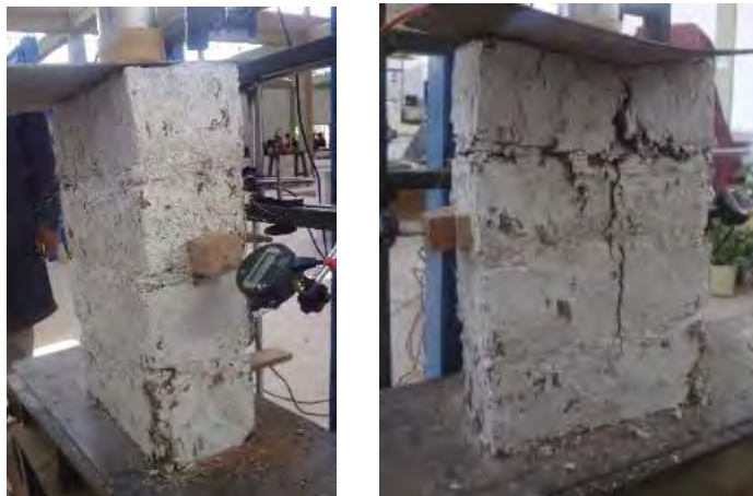
Figura 3.26 Ensayo de compresión simple y la posterior falla de la pila N° 01. Fuente: Elaboración propia, 2019.
