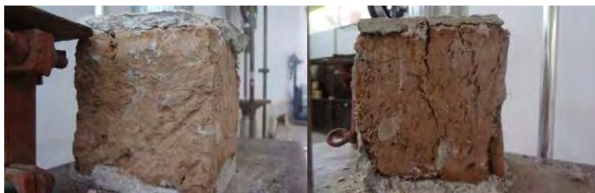
Figura 3.21. Ensayo de compresión simple y posterior falla del espécimen en la máquina de compresión simple. Fuente: Elaboración propia, 2019.
