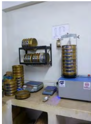
Figura 3.37 Tamices utilizados en el ensayo de análisis granulométrico. Fuente: Laboratorio, 2019.
