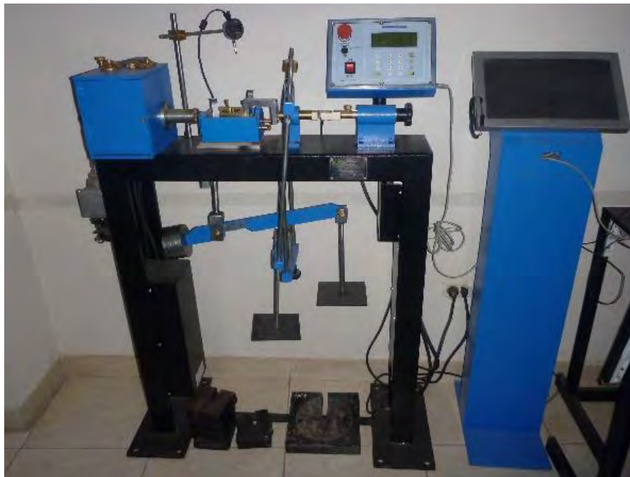
Figura 3.38 Equipo utilizado en el ensayo de corte directo, para determinar la capacidad portante del suelo. Fuente: Laboratorio, 2019.
