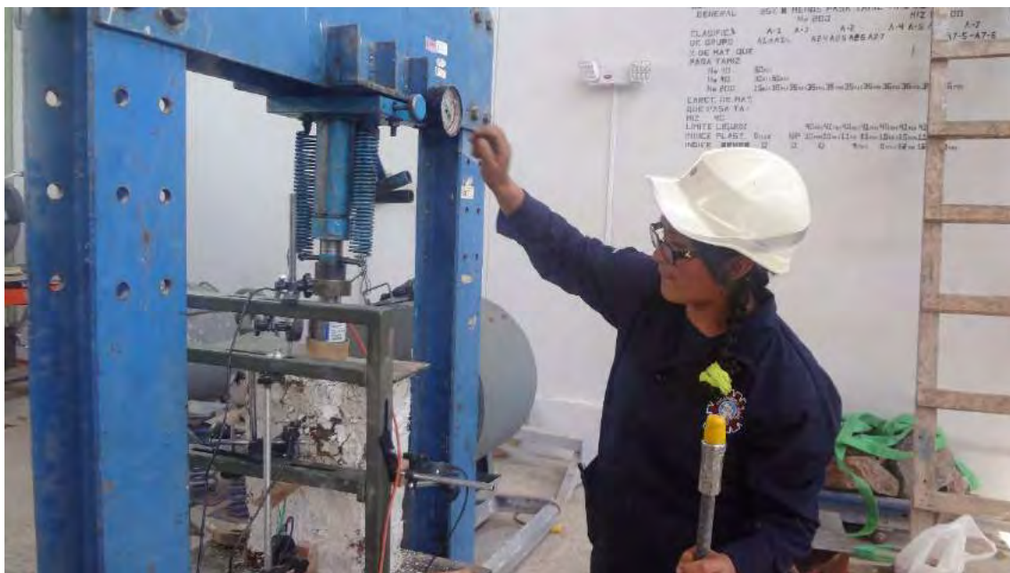
Ensayo de compresión simple en pilas de adobe, en laboratorio de Mecánica de Suelos y Materiales de la Escuela Profesional de Ingeniería Civil, UNSAAC.
