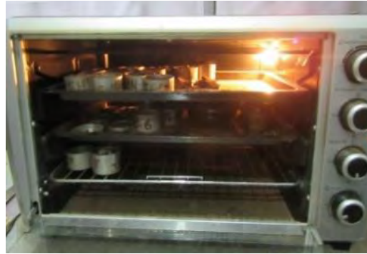
Figura 3.36 Horno utilizado en el ensayo de contenido de humedad. Fuente: Laboratorio, 2019.
