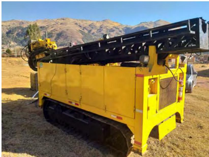
*Foto N° 10.1 Equipo de Perforación CC-4000*
