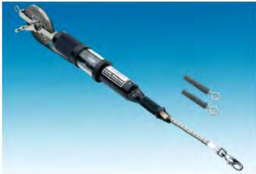
Fotografía N° 3 Extensómetro de cinta para mediciones de convergencia
