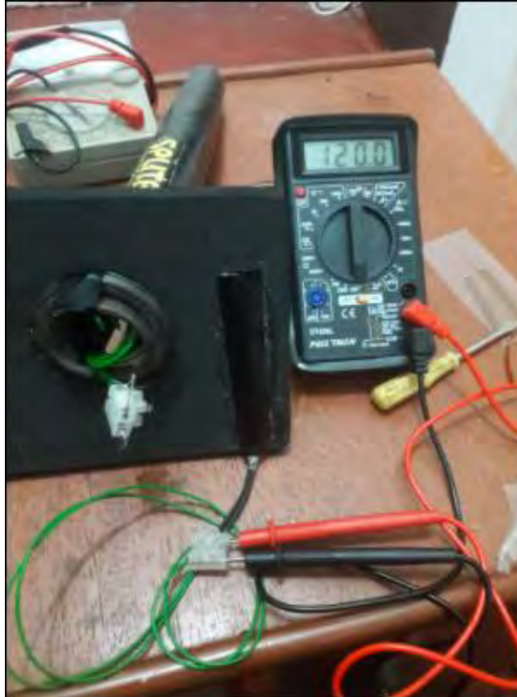
Fotografía N° 14 Calibración con galga extensómetra
